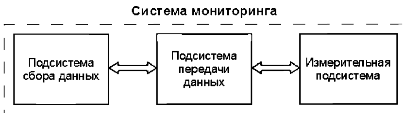
Рисунок 5.1 – Структурная схема системы мониторинга
