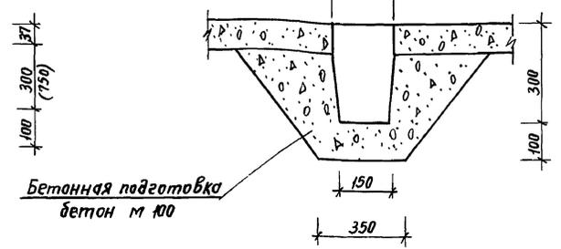
1. Колодцы выполнять при устройстве бетонной подготовки под полы
