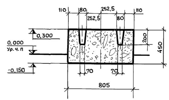
Фундаменты под оборудование выполнить из бетона М 150.
