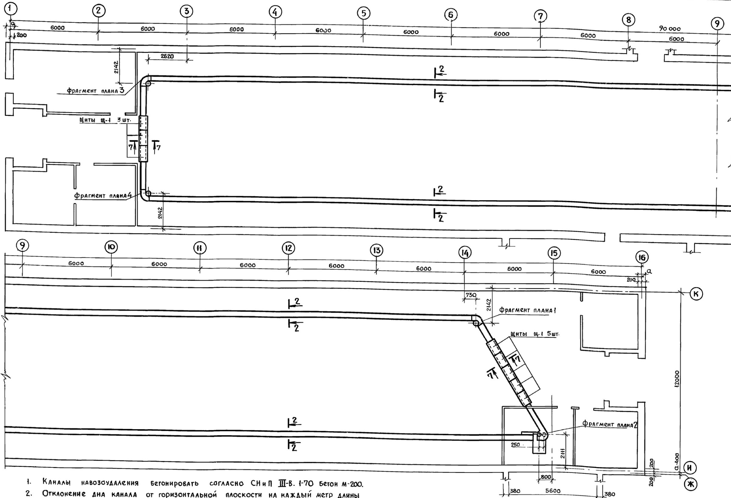
1. Каналы навозоудаления бетонировать согласно СНиП III-B. 1-70 бетон м-200.
