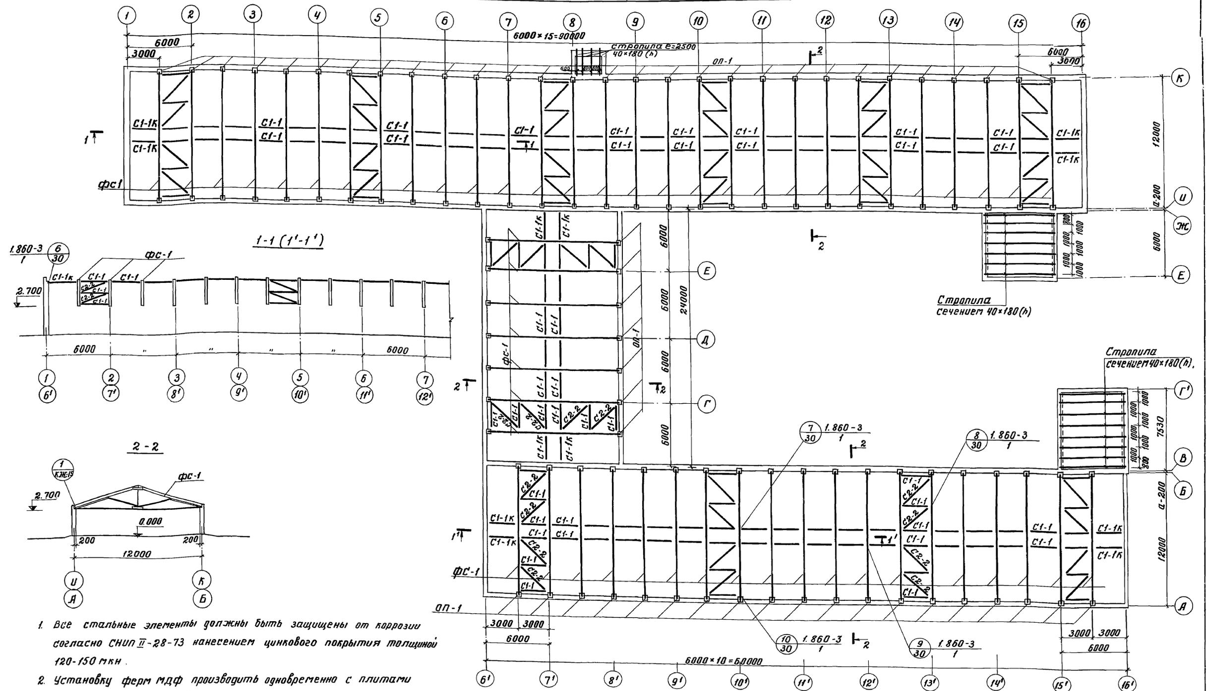
1. Все стальные элементы должны быть защищены от коррозии согласно СНиП II-28-73 нанесением цинкового покрытия толщиной 120-150 мкм.
