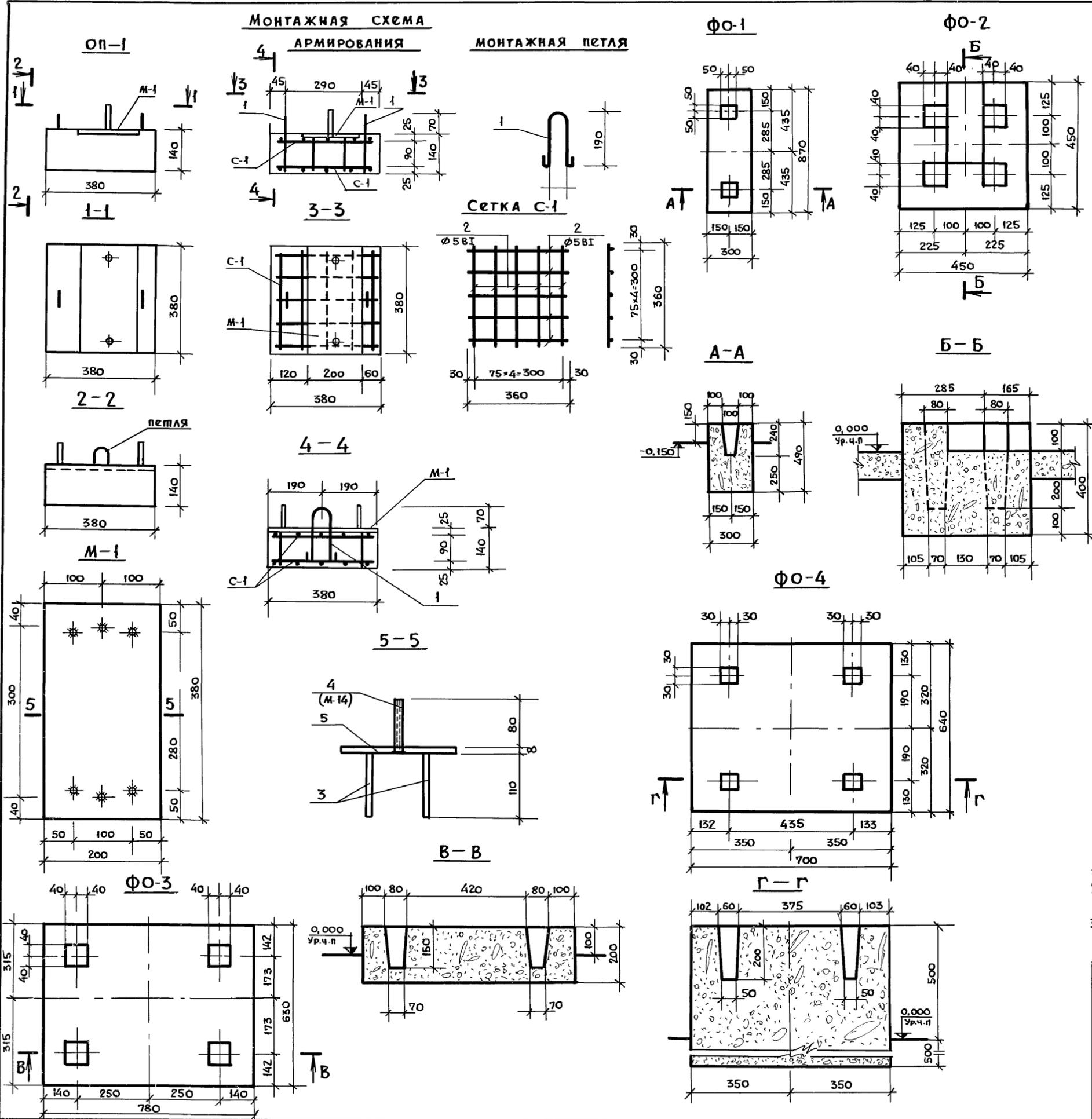
Спецификация бетонных фундаментов.
