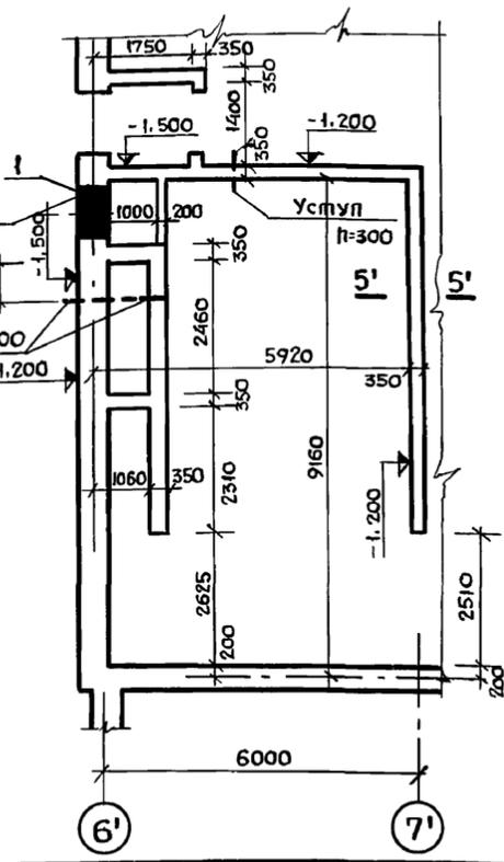
1. За условную отметку 0,000 принята отметка дна навозного канала под скреперную установку, что соответствует абсолютной отметке [ ]
