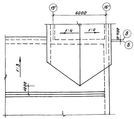
Фрагмент примыкания помещения погрузки навоза по оси „Ж“.
