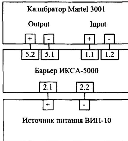
Рисунок 1 - Схема измерений силы постоянного тока
