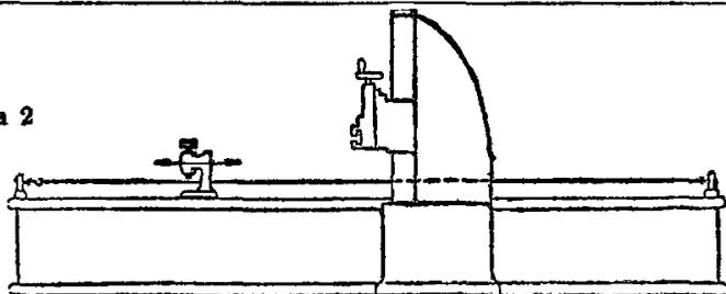
**Технические условия.** Направляющие станины должны быть прямолинейны в продольном направлении в горизонтальной плоскости.
