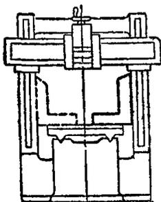
**Технические условия.** Стойки должны быть перпендикулярны к поверхности стола в плоскости, перпендикулярной к его движению. Для станков с одной стойкой допускается наклон верхнего конца стойки только к столу.
