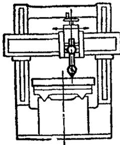
**Технические условия.** Направляющие траверсы должны быть параллельны поверхности стола. Для станков с одной стойкой отклонение свободного конца траверсы допускается только вниз.
