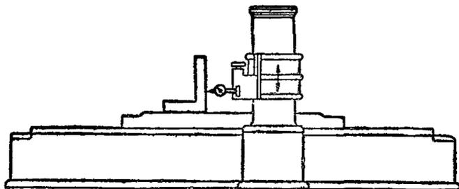
**Технические условия.** Для станков с одной стойкой. Стойка должна быть перпендикулярна к поверхности стола в плоскости направления его движения.
