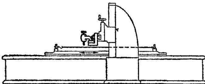
**Технические условия.** Движение стола должно быть прямолинейно в горизонтальной плоскости.
