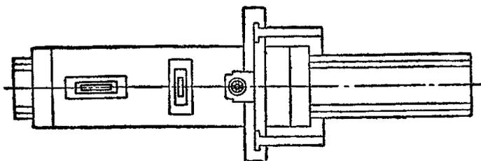
**Технические условия.** Поверхность стола в различных положениях при его перемещении должна совпадать с горизонтальной плоскостью.
