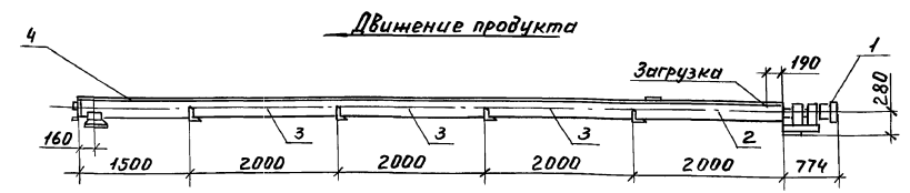
Конвейер винтовой У21-БКВ-16-16 поз. 23.
