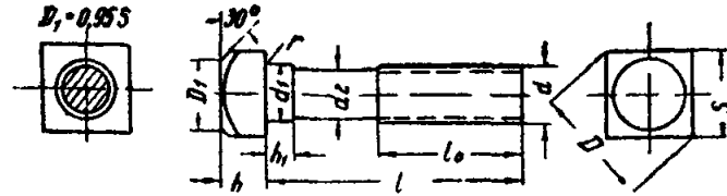
Тип 2. Болты с квадратной уменьшенной головкой Основные размеры
