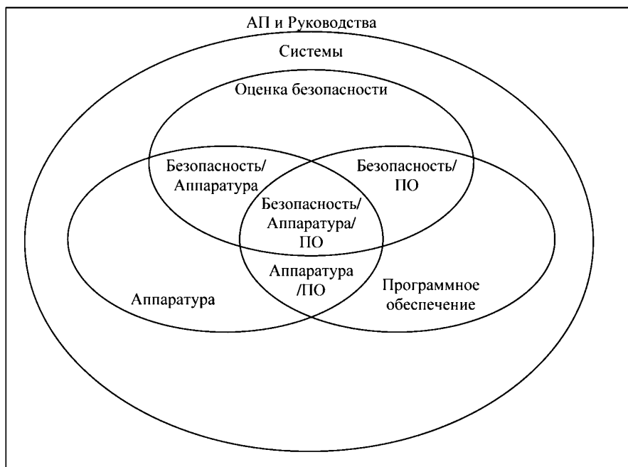
Рисунок 2-1. Взаимоотношение между бортовыми системами, оценкой безопасности и процессами аппаратных средств и ПО
