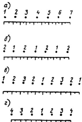
Рис. 4. Схема короткозамедленного взрывания при однорядном расположении зарядов
