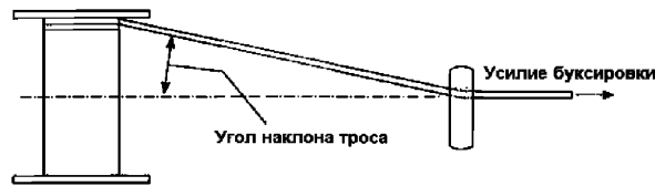
Рис. 6.6.1-2 Угол наклона троса по отношению к барабану лебедки
