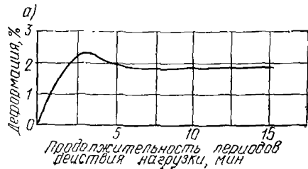
РИС. 35. ЗАВИСИМОСТЬ ДЕФОРМАТИВНОСТИ ПРИ РАССТЯЖЕНИИ ПОЛИСТИРОЛЬНОГО ПЕНОПЛАСТА ( \gamma = 30 кг/м 3 ) ОТ РЕЖИМА ВОЗДЕЙСТВИЯ ПОВТОРНЫХ НАГРУЗОК, СОСТАВЛЯЮЩИХ 0,5 ОТ \sigma_p (КОЛИЧЕСТВО ЦИКЛОВ 62)
