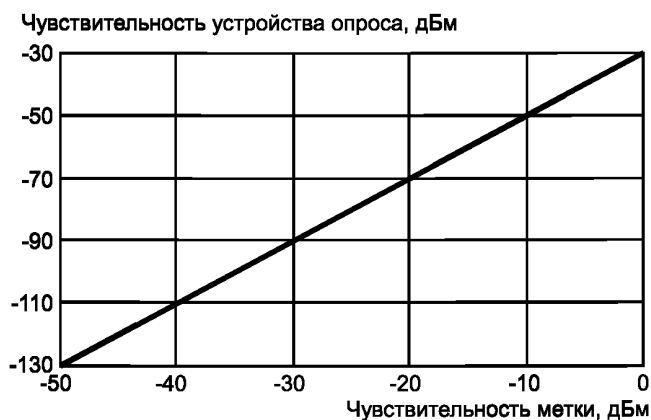
Рисунок Q.1 — Соотношение чувствительности устройства опроса и радиочастотной метки при условии согласования линий радиочастотной идентификации по дальности действия
