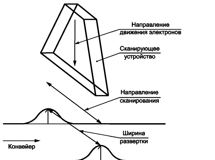
Рисунок 1 — Схема облучения при использовании конвейерной системы перемещения продукции
