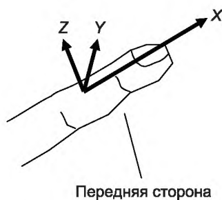
Рисунок 3 — Стандартное положение и система координат пальца. Правосторонняя система координат
