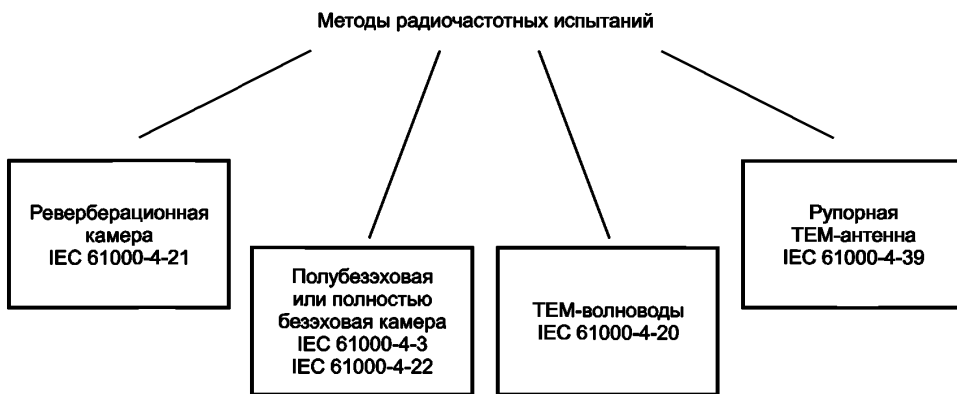
Рисунок 1 — Обзор методов испытаний, которые могут быть использованы для оценки устойчивости оборудования к помехам от радиопередатчиков
