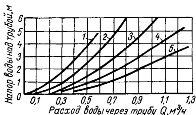
Рис. 47. График для расчета труб водосборных колодцев 1 — 300 мм; 2 — 350 мм; 3 — 400 мм; 4 — 450 мм; 5 — 500 мм
