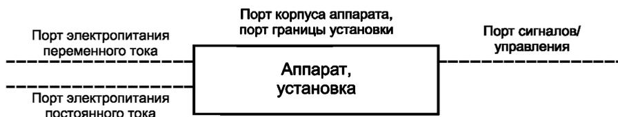
Рисунок 1 — Примеры портов аппарата и установки
