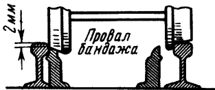
Рис. 15. Понижение остряка против рамного рельса
