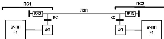
Рисунок 4 – Организация каналов ВЧ защит на ЛЭП без ответвления
