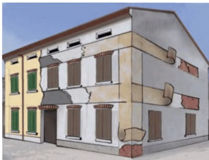
Рисунок 11.8. Поверхностное армирование сетками из композитных материалов угловых зон и междуоконных поясов
