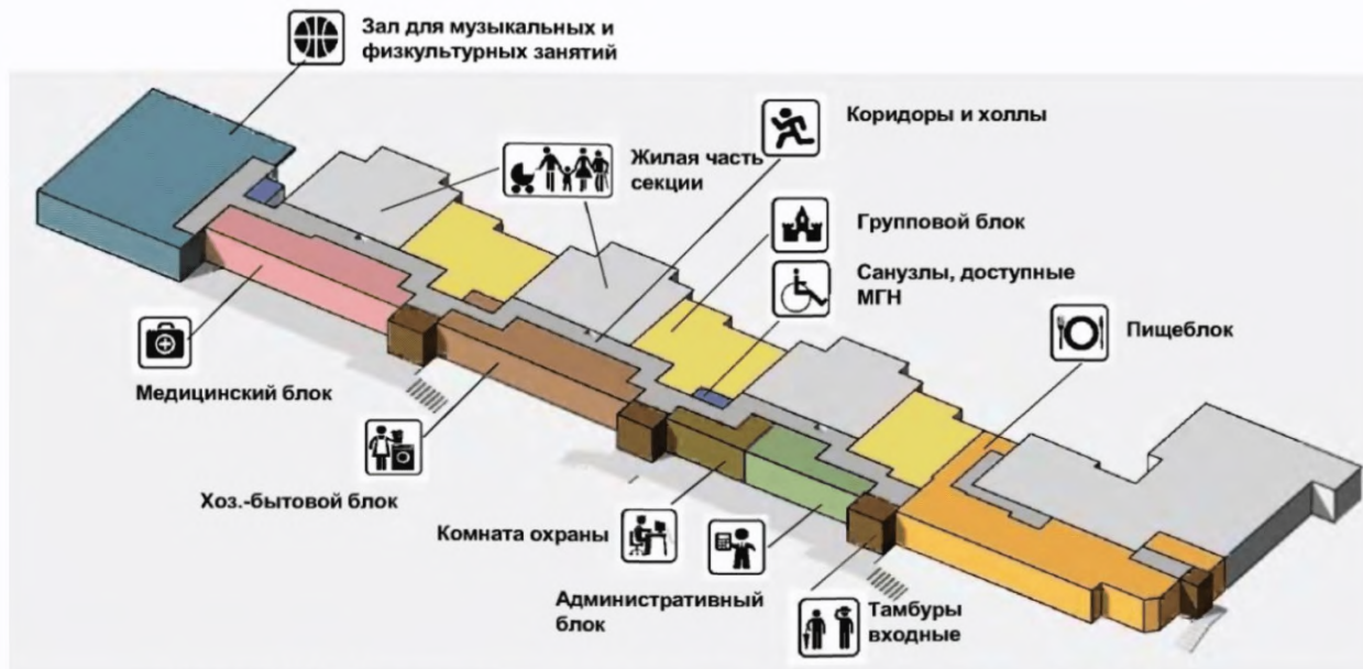
Рисунок Ж1 - Схема функционального зонирования встроенно-пристроенного ДОО
