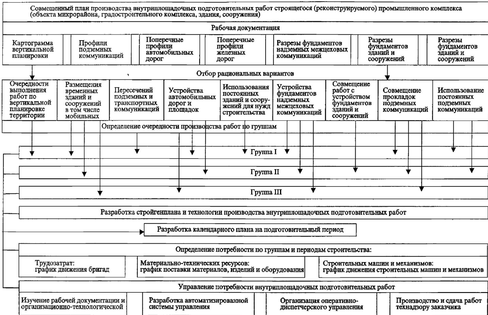
Рисунок 7.6 – Принципиальная схема разработки решений по инженерной подготовке территории
