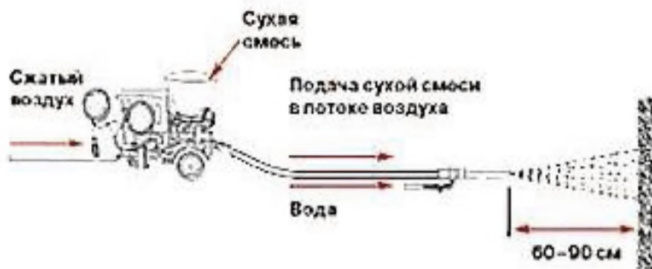
Рисунок 10.3 – Схема сухого способа пневмобетонирования (торкретирования)
