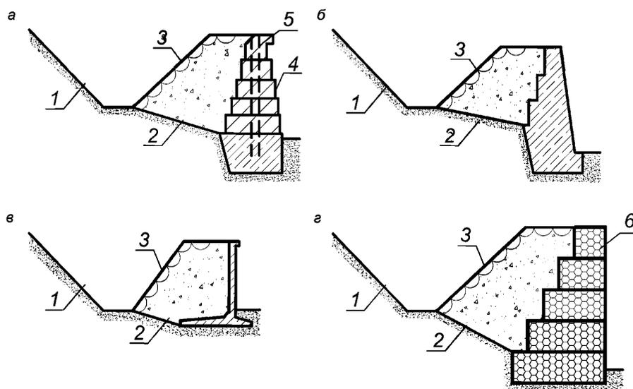
а — стена из бетонных блоков; б — стена из коробчатых габионных конструкций; в — стена из монолитного железобетона;
