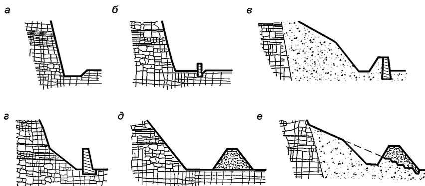
а — улавливающая траншея; б — улавливающая полка с бордюром; в — улавливающая стена; г — оградительная улавливающая стена; д — улавливающий вал у подошвы; е — улавливающий вал на склоне
