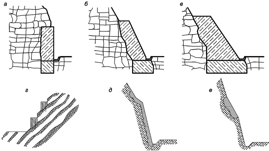
а — поддерживающая стена; б — подпорная стена; в — контрфорс; г — опояски; д — облицовочная стена; е — плomba
