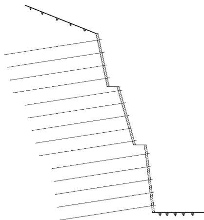
Рисунок 6.6 — Нагельное крепление с упорными плитами
