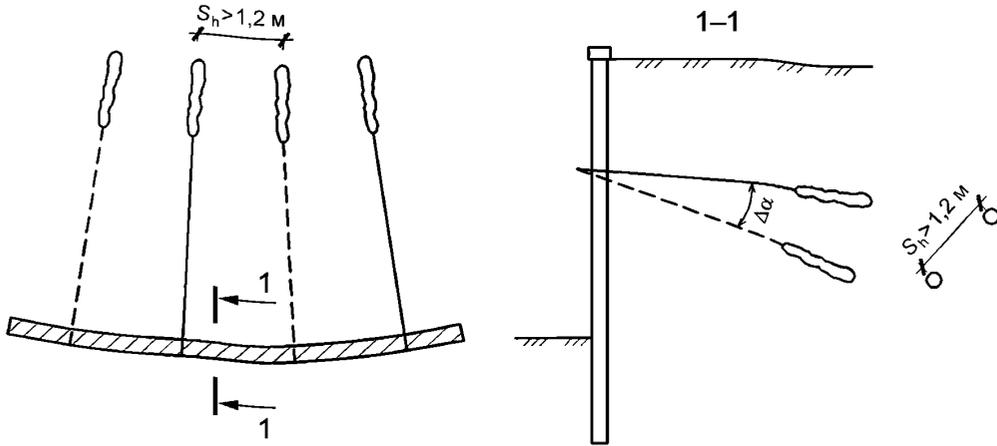
Рисунок 6.10 — Расположение анкеров на криволинейных участках сооружения
