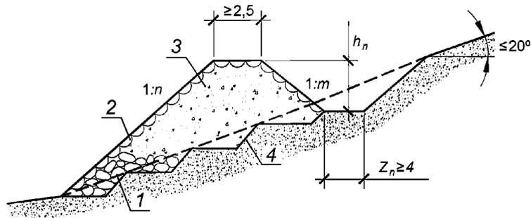
1 — упор из каменной кладки; 2 — укрепление откоса; 3 — вал из местного грунта; 4 — уступы в основании вала (штрабы); 1:n — крутизна низового откоса; 1:m — крутизна верхового откоса;  $h_n$  — высота улавливающего вала;  $Z_n$  — высота штрабы
