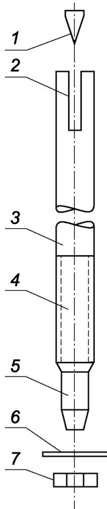
1 — клин; 2 — прорезь; 3 — стержень; 4 — участок с резьбой; 5 — хвостовик (под насадку при установке);
