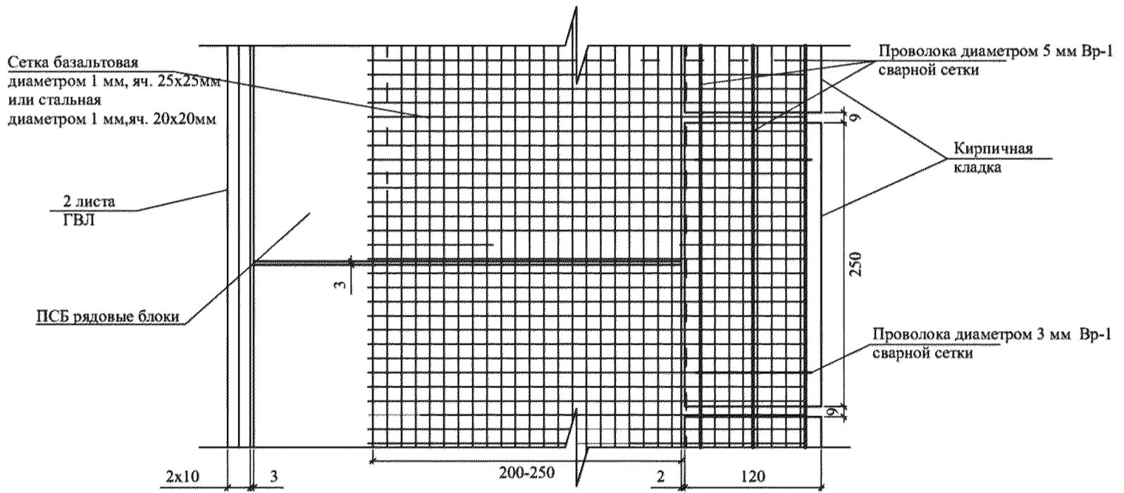
Рисунок 6.16 — Крепление кирпичного облицовочного слоя к кладке из ПСБ блоков с использованием штукатурной сетки
