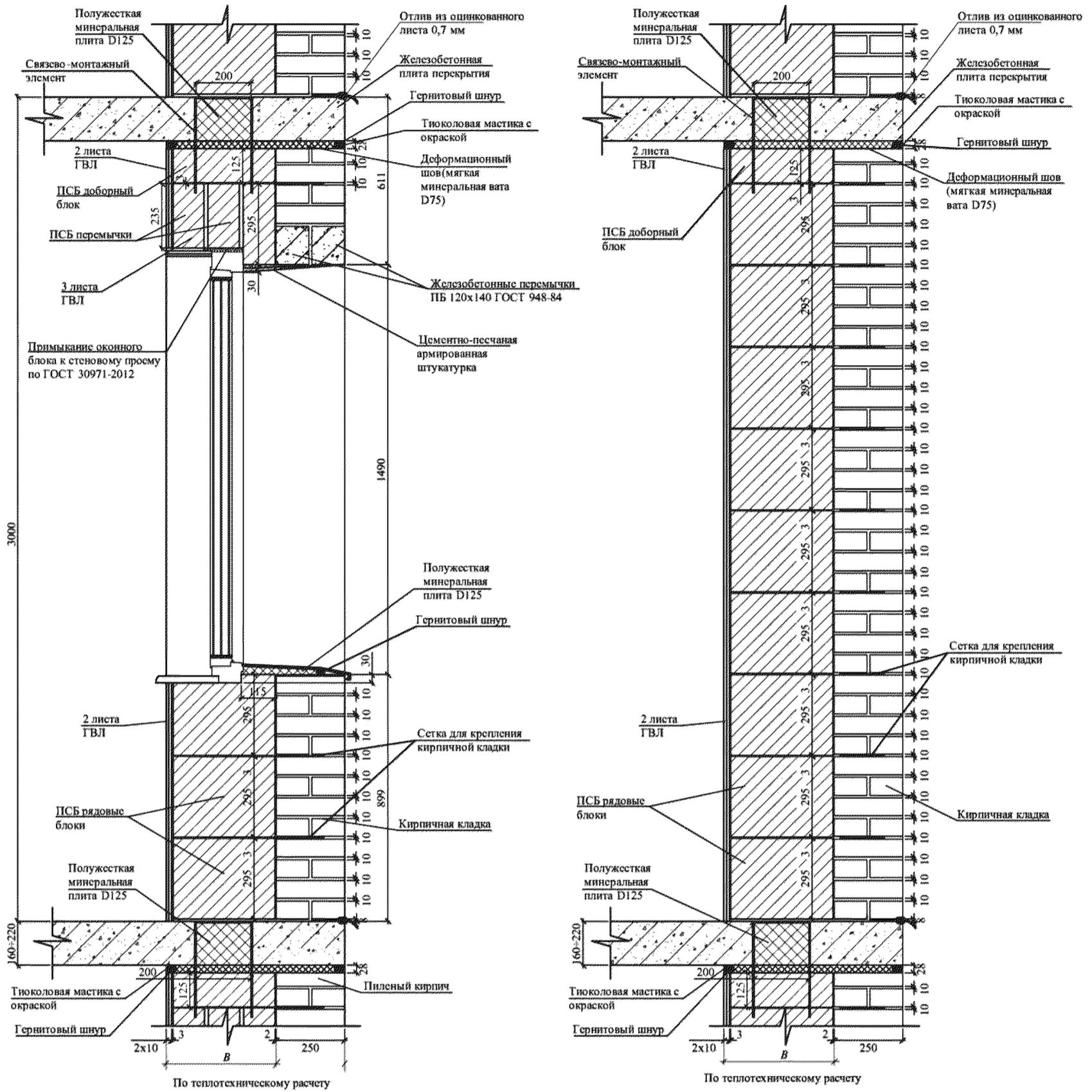
Рисунок 6.4 — Несущая стена из полистиролбетонных блоков с наружной кирпичной облицовкой толщиной 250 мм и внутренней облицовкой ГВЛ. Вертикальные разрезы по оконному проему и глухому простенку
