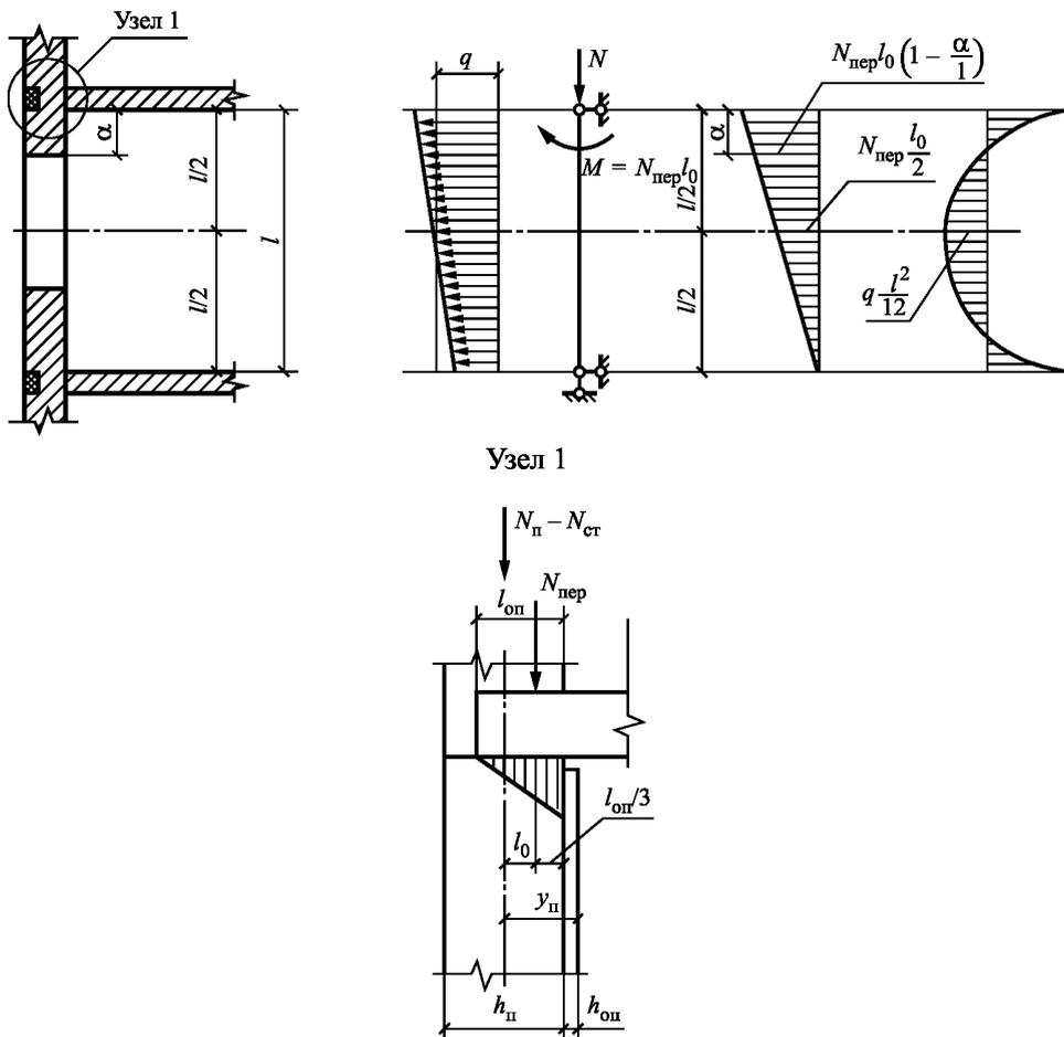
Рисунок 7.9 — Конструктивная и расчетная схема несущей части стены
