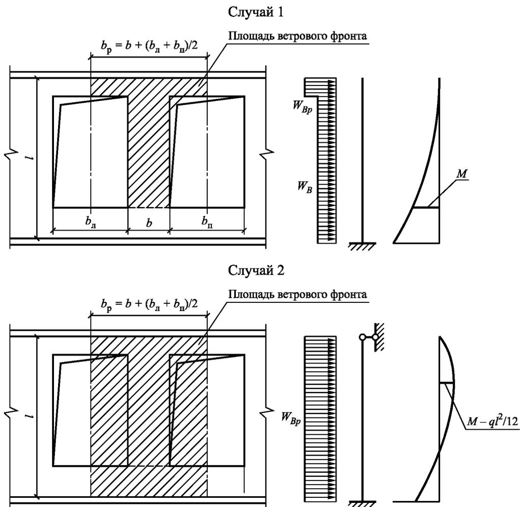
Рисунок 7.5 — К расчету простенка, расположенного вне несущих поперечных стен, на стадии возведения
