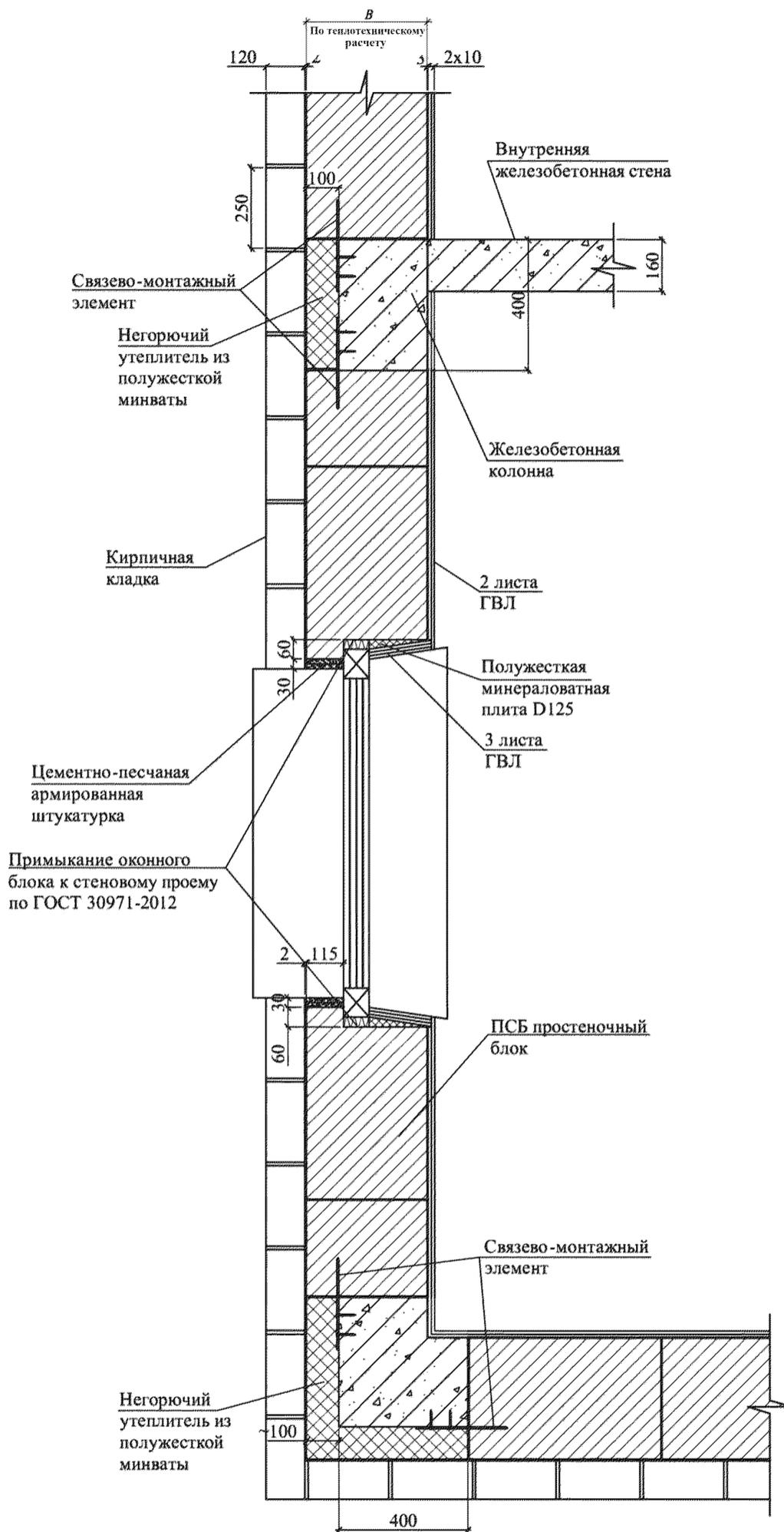
Рисунок 6.5 — Несущая стена из ПСБ блоков с несущими железобетонными колоннами и кирпичной облицовкой фасада. Горизонтальный разрез
