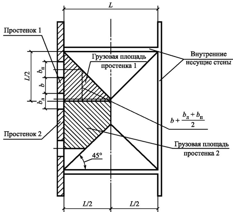
Рисунок 7.8 — Схема определения грузовой площади стены
