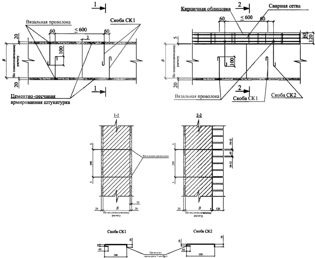
Рисунок 6.17 — Крепление облицовочных штукатурных и кирпичных слоев к кладке из ПСБ блоков с использованием проволочных хомутов
