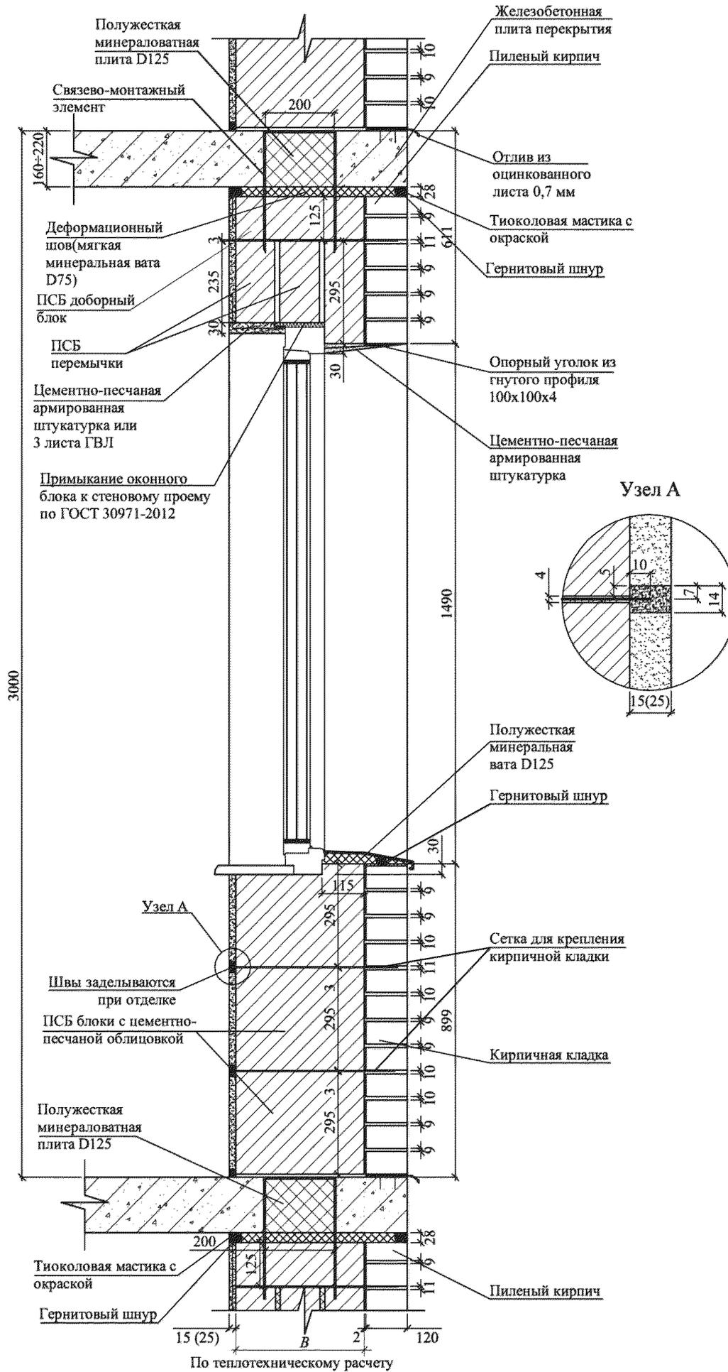
Рисунок 6.6 — Несущая стена из ПСБ блоков с заводской цементно-песчаной и кирпичной фасадной облицовкой толщиной в 0,5 кирпича. Вертикальный разрез по оконному проему
