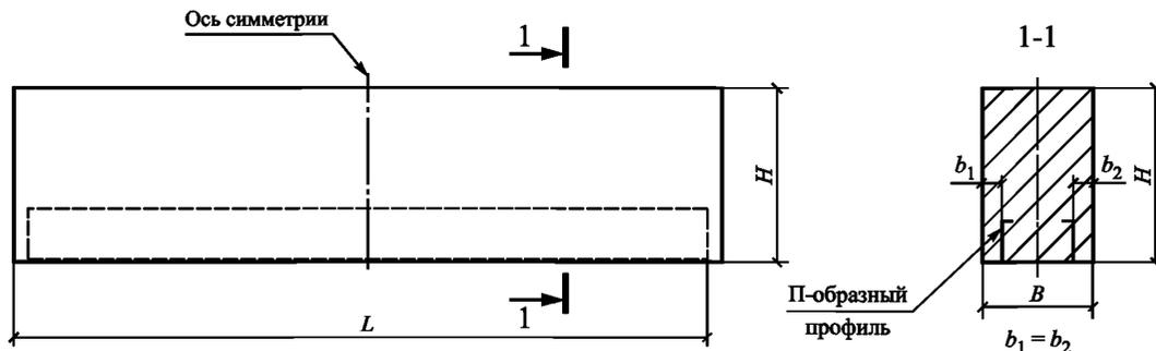
Рисунок 4.2 — Полистиролбетонная перемычка, армированная П-образным стальным оцинкованным профилем
