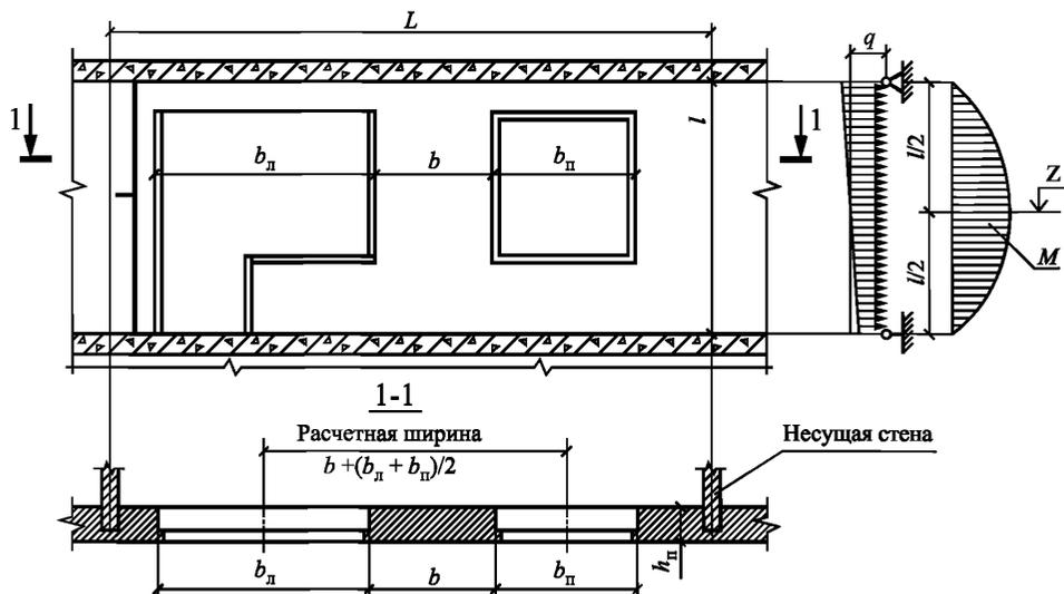
Рисунок 7.1 — К расчету простенка на ветровую нагрузку
