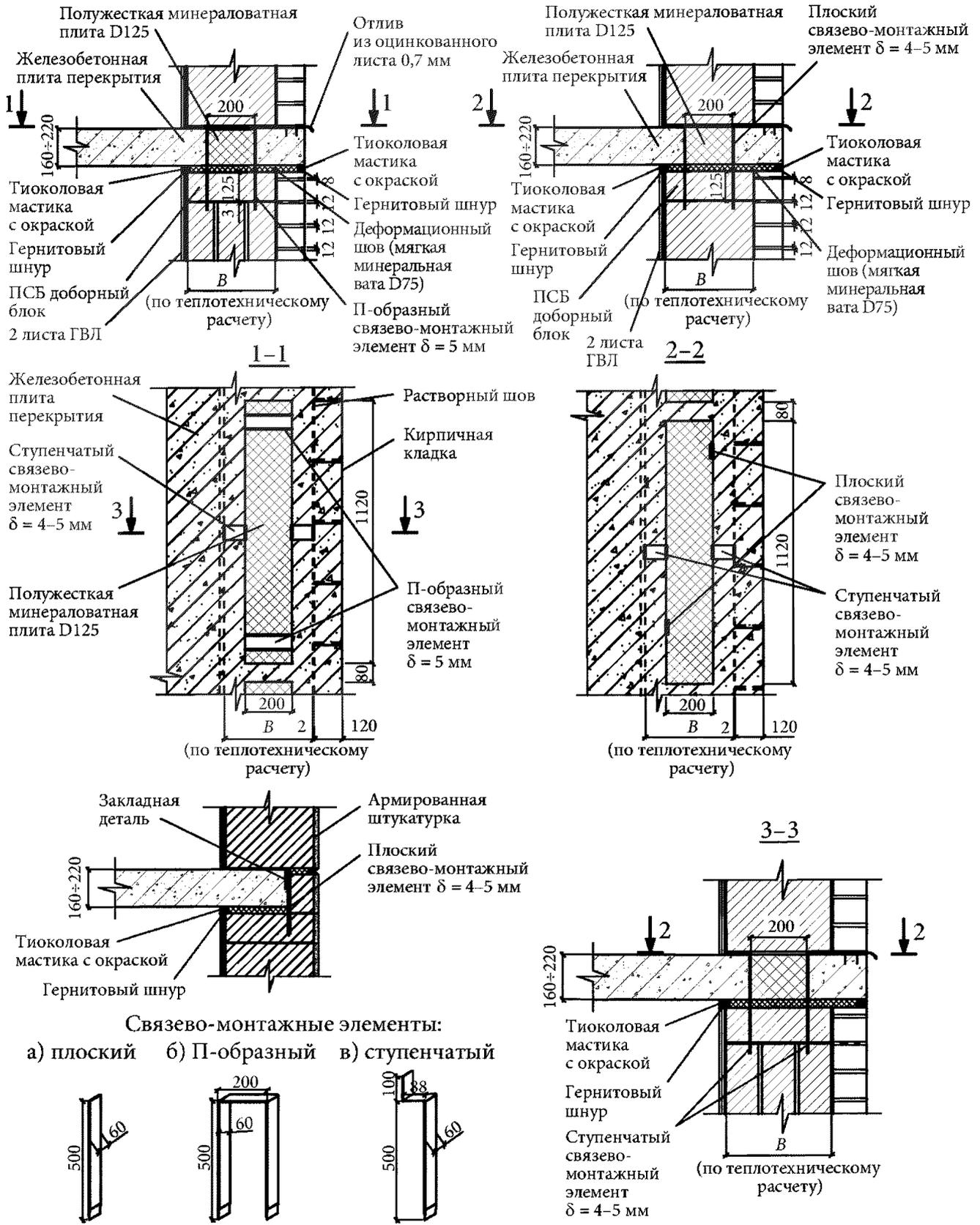
Рисунок 6.20 — Крепление кладки из ПСБ блоков к железобетонным перекрытиям
