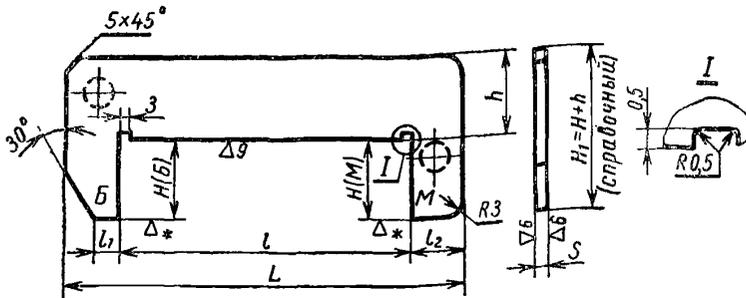
\* Чистота обработки рабочих поверхностей устанавливается в соответствии с ГОСТ 2015—53 п. 1.
