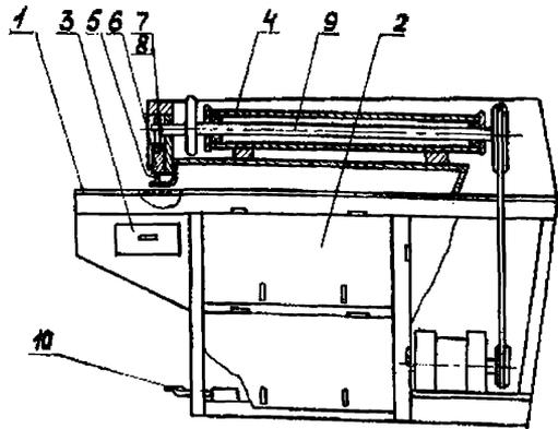
Рис. П.5.7. Ножницы для вырезки прокладок:
