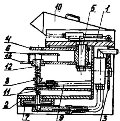
Рис. П. 5.4. Пресс пневматический для вырубki отверстий в прокладках:
