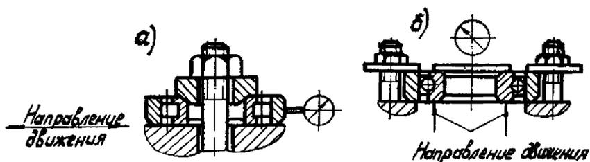
Рис. 9. Схемы определения зазоров подшипников качения:
