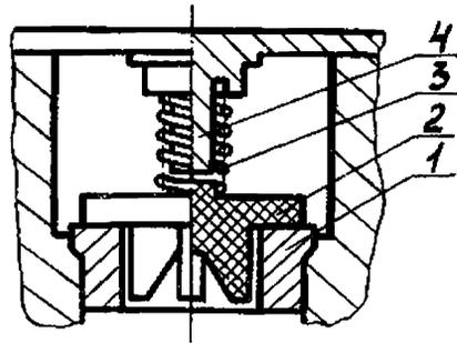
Рис. 12. Клапанная коробка насоса 1СП с капроновым клапаном:
