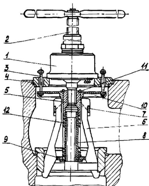
Рис. П.5.6. Приспособление для демонтажа седел клапанов гидравлической части паровых насосов НПС-3 и ИПС (тип II):
