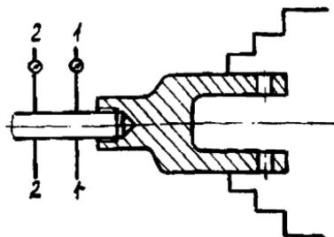
Рис. 8. Проверка несоосности и переко-
