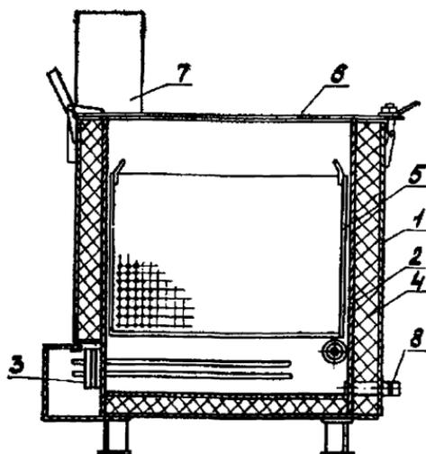
Рис. П.5.8. Ванна масляная для подогрева деталей:
