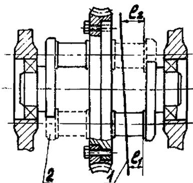
Рис. П.10.7. Проверка перпендикулярности оси вала к оси ряда:
