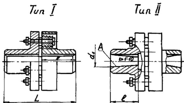
Рис. 22. Муфты упругие втулочно-пальцевые.
