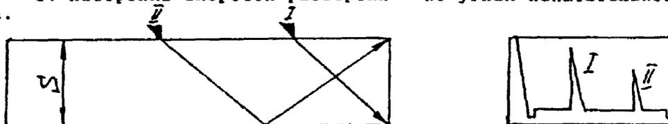
6. Настройка глубиномера производится по таблице 1 в положении ПЭП согласно рисунка.
