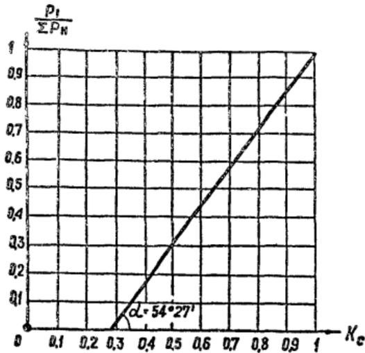
Рис.П.4.1. Зависимость коэффициента спроса  $K_c$  от отношения  $\frac{P_t}{\Sigma P_n}$  при применении оборудования с индивидуальным креплением
