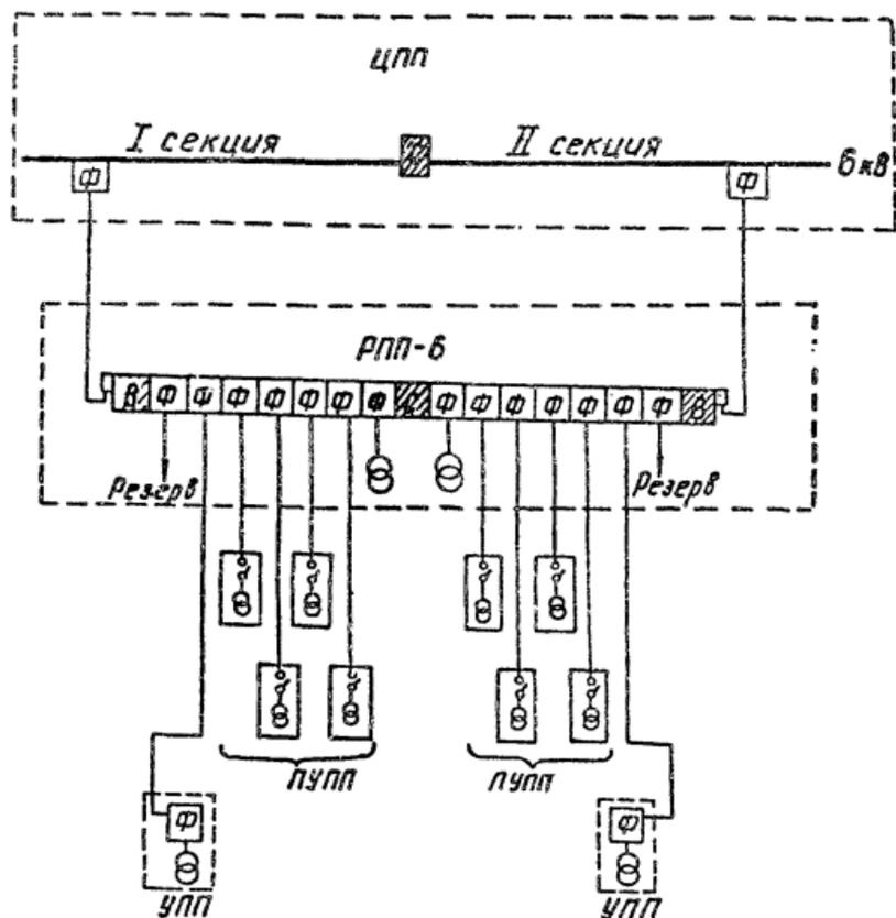
Рис.3. Принципиальная схема питания РПП-6 при количестве присоединений свыше 7\*
