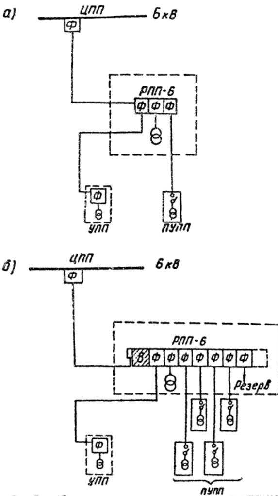
Рис.2. Принципиальная схема питания РПП-6 при количестве присоединений:
