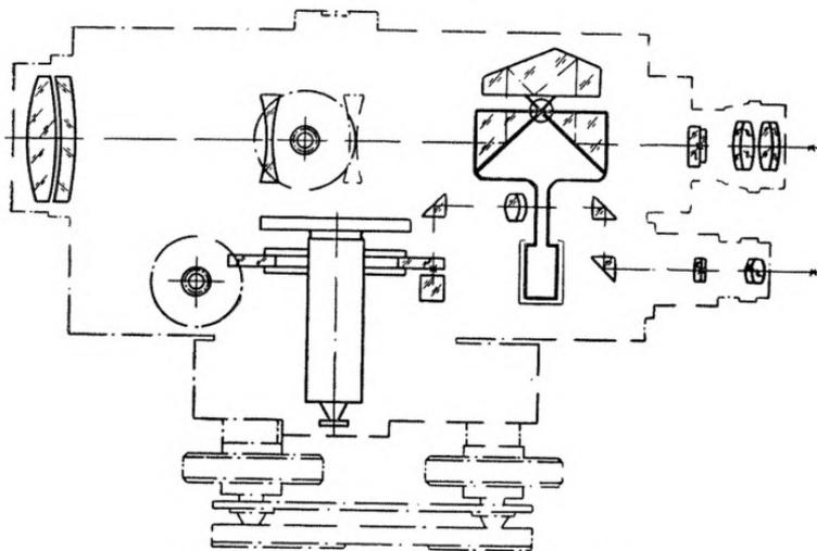
Рис. 41. Оптическая схема нивелира Ni025.
