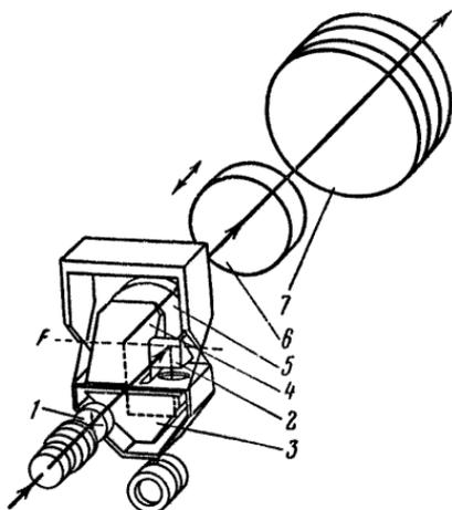
Рис. 37. Оптическая схема нивелира NiB.
