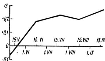
Рис. 88. График интерполирования поправки за среднюю длину метра комплекта реек.
