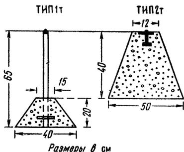
Рис. 16. Реперы для закрепления линий технического нивелирования.
