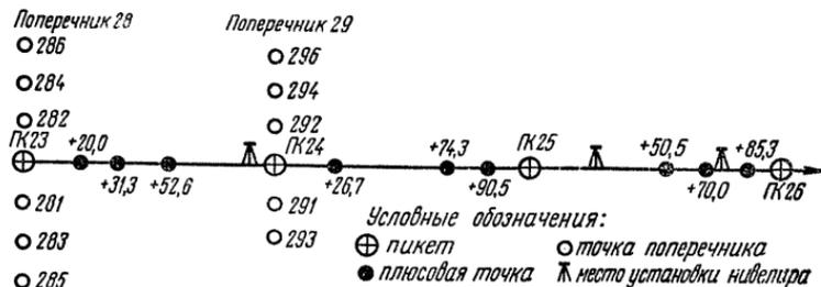
Рис. 71. Участок линии технического нивелирования.
