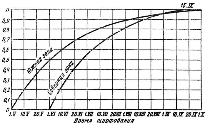
Рис. 6. График для определения показания протаивания.
