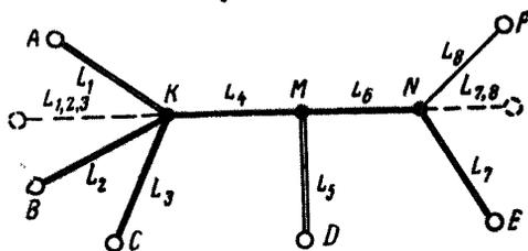
Рис. 93. Уравнивание сети нивелирных линий методом эквивалентной замены.
