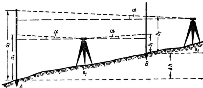
Рис. 58. Определение угла  $i$  нивелира вторым способом.
