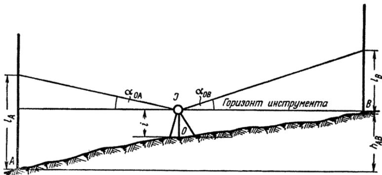
Рис. 85. Измерение превышений тригонометрическим нивелированием методом из середины.
