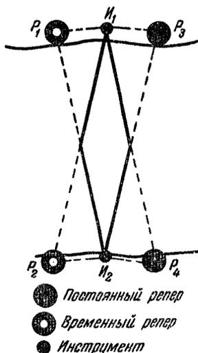
Рис. 69. Передача через препятствия шириной более 200 м.
