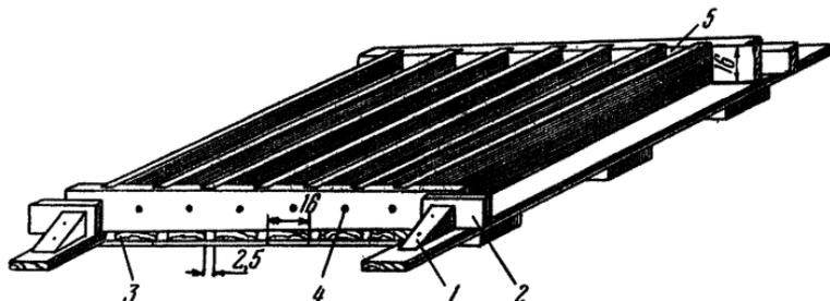
Рис. 21. Многоячейковая опалубка.
