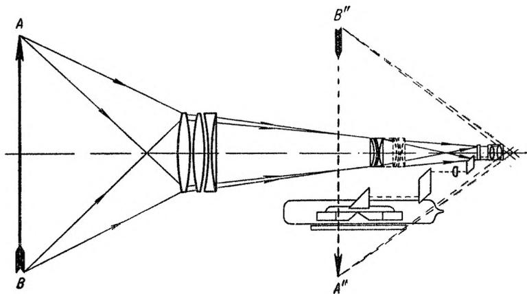
Рис. 25. Оптическая схема нивелира НЗ.
