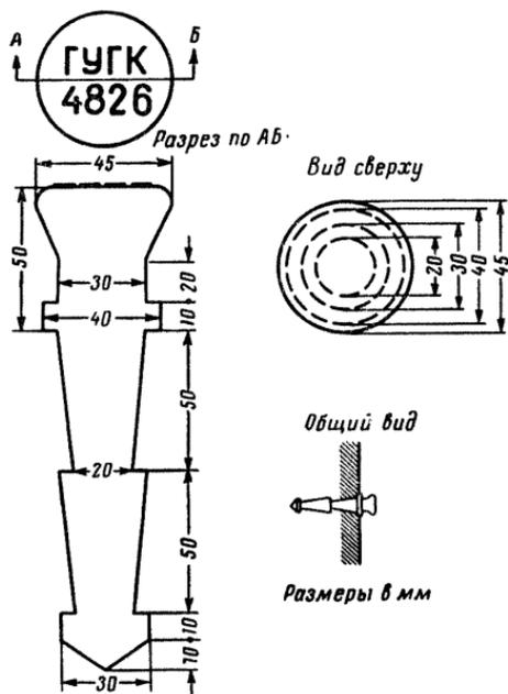
Рис. 7. Стеной репер.
