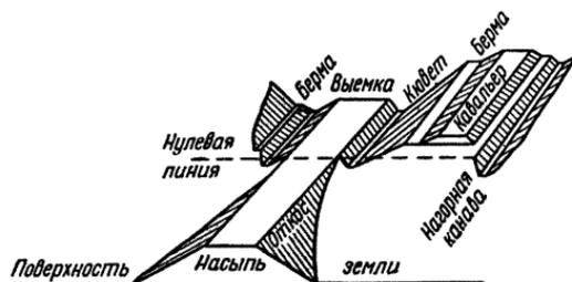
Рис. 81 Элементы земляного полотна.
