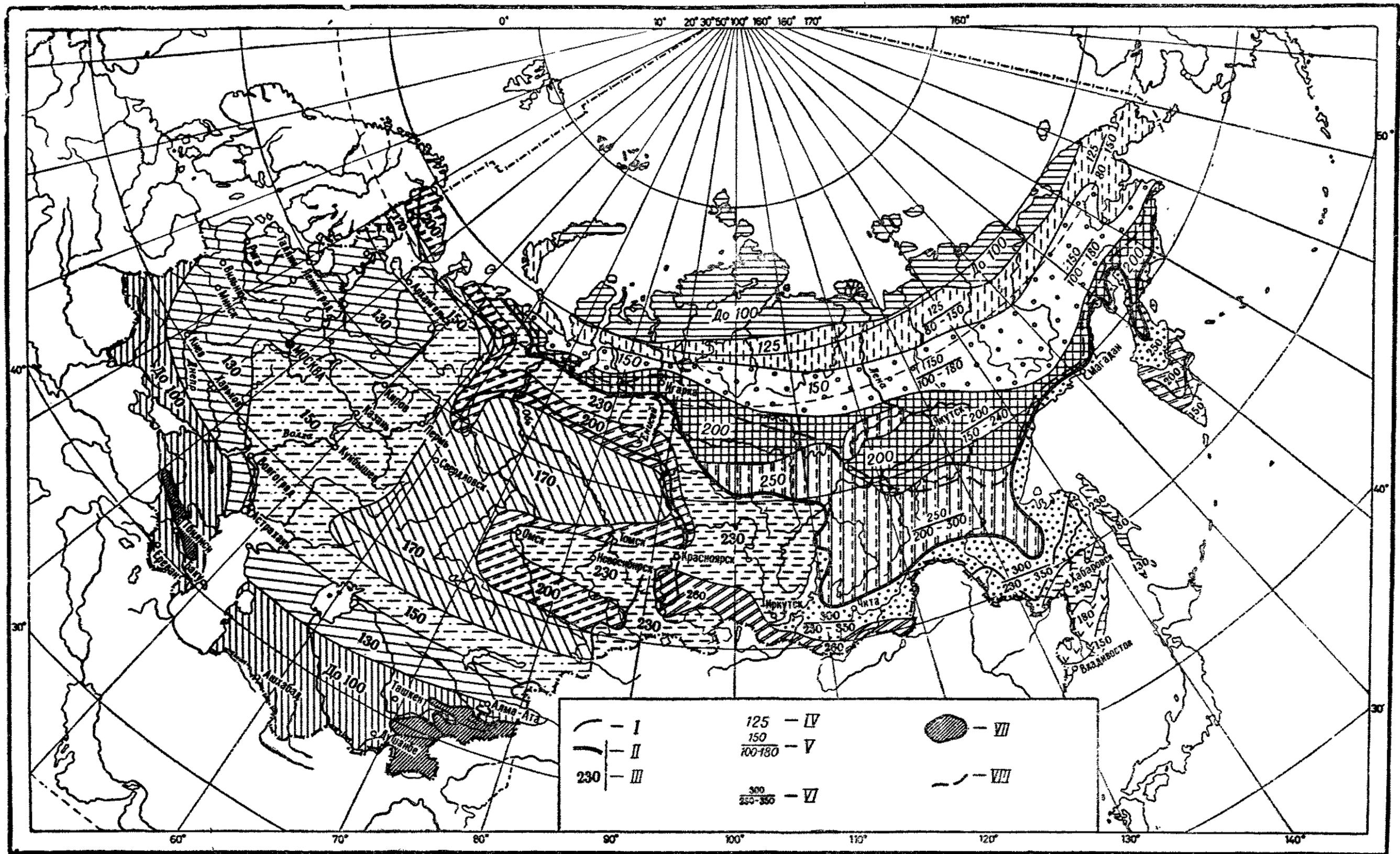
Рис. 5. Схематическая карта глубин промерзания и протаивания грунтов на территории СССР для установления глубины закладки центров и реперов.
