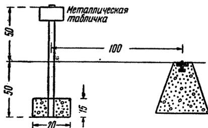
Рис. 19. Трубчатый опознавательный знак для реперов технического нивелирования.
