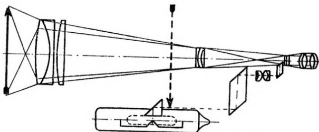
Рис. 43. Оптическая схема нивелира НТ.
