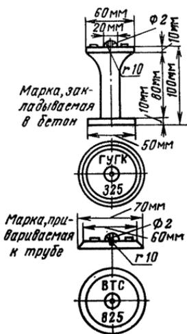
Рис. 10. Марки для грунтовых реперов.
