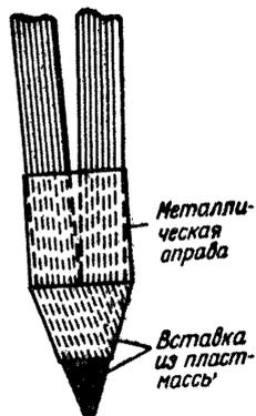
Рис 51. Пластмассовая вставка в металлический наконечник ножек штатива
