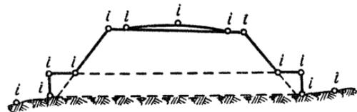
Рис. 82. Места установок рейки при нивелировании труб.
