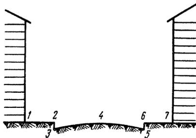
Рис. 80. Места установок реек при нивелировании улицы.
