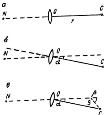
Рис. 31. Принцип работы нивелира с компенсатором.
