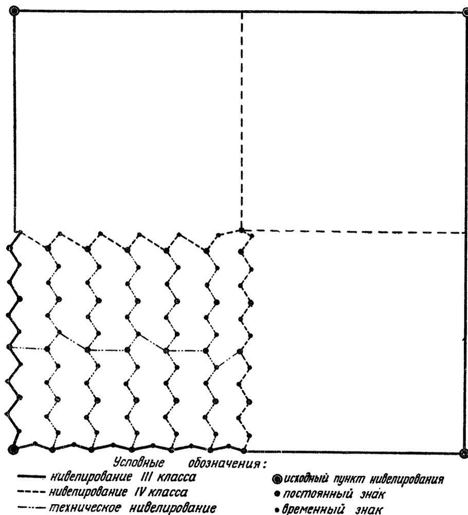
Рис. 4. Схема нивелирной сети на объекте площадью около 1000 км<sup>2</sup>.
