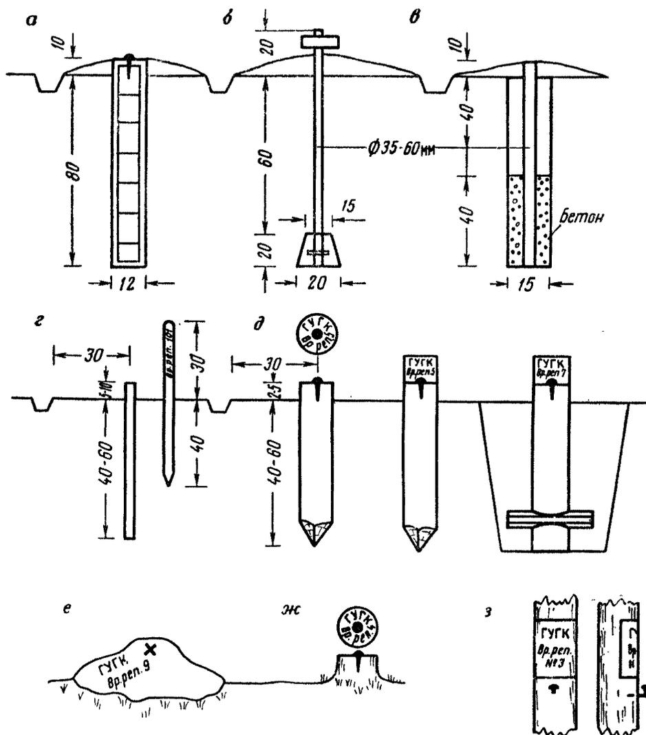
Рис. 20. Временные реперы для зоны сезонного промерзания:
