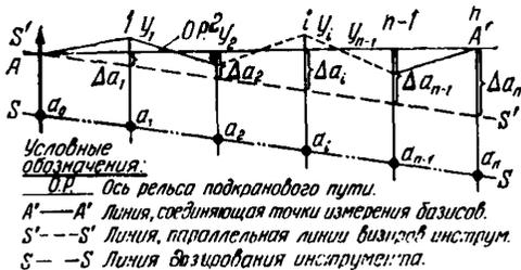
Рис. 22. Контроль точности монтажа подкрановых путей произвольных створов
