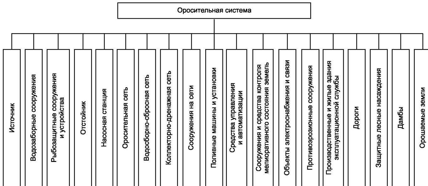
Рисунок А.1 — Состав элементов оросительной системы
