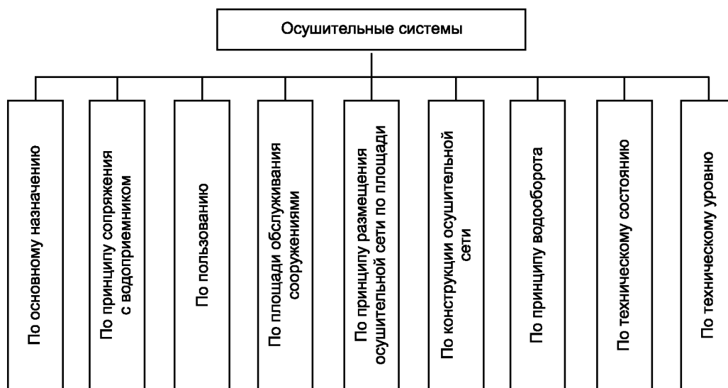
Рисунок Б.2 — Классификация осушительных систем по основным признакам
