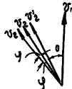
Рис 17. Векторные диаграммы напряжения при включении дополнительного трансформатора в расщепку с целью обогрева.
