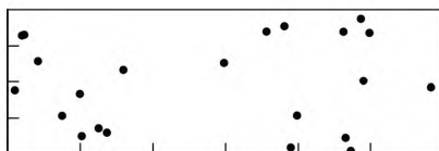
Рисунок А.2 — Пористость 1,5 %, 23 поры, d = 1 мм
