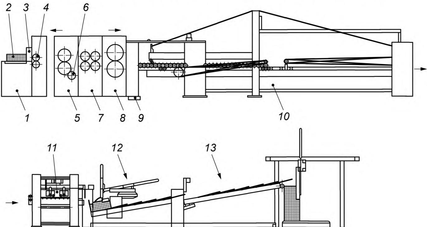
1 — секция подачи заготовок; 2 — пачка заготовок; 3 — устройство бокового равнения; 4 — подающие валики; 5 — печатная секция; 6 — красочный валик; 7 — секция продольной резки, рилевки (биговки); 8 — ротационное высекальное устройство; 9 — лента транспортера для удаления отходов; 10 — фальцевальная секция; 11 — проволокошвейная секция; 12 — секция счетно-выталкивающая, выравнивающая сгиб картонных коробок; 13 — приемное устройство
