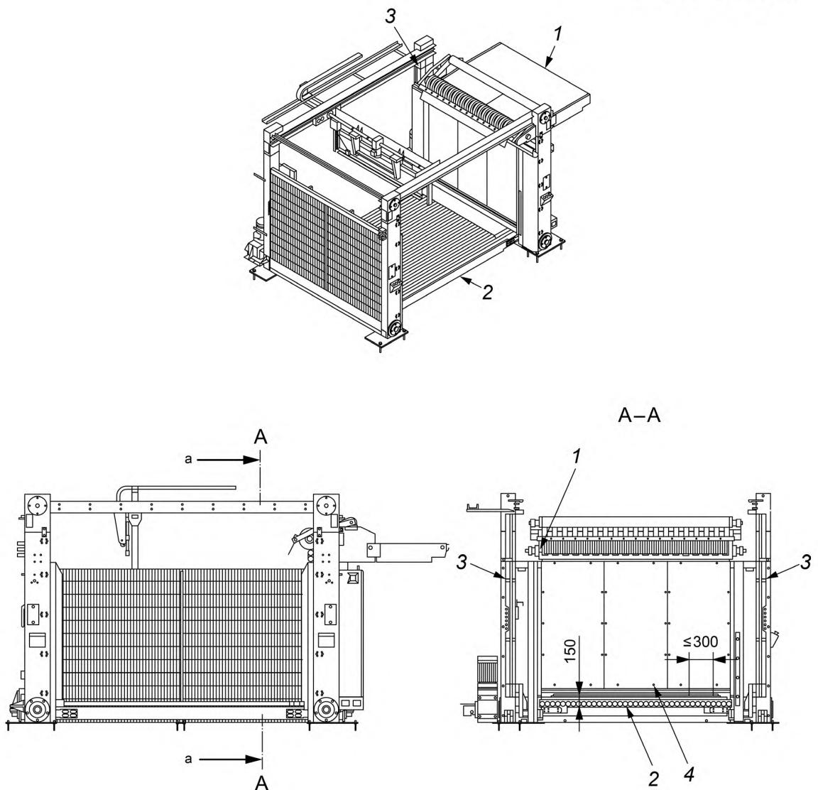
1 — загрузочный ленточный транспортер; 2 — приемный стол (роликовый конвейер); 3 — цепь;
