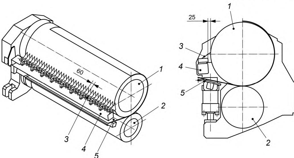
1 — верхний гофрировальный вал; 2 — нижний гофрировальный вал; 3 — шабер; 4 — поперечная штанга; 5 — ввод полотна бумаги
