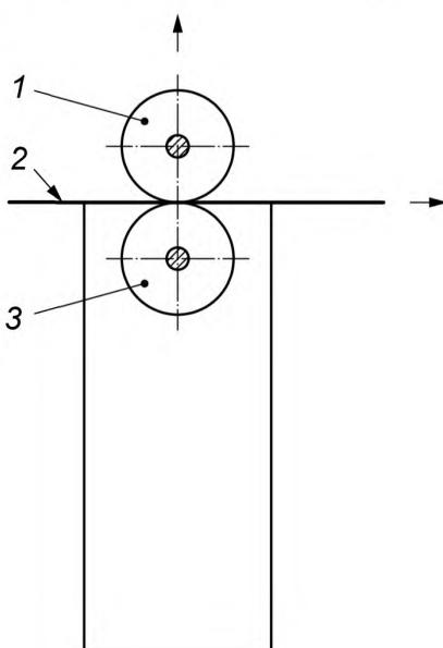
1 — верхний протягивающий вал; 2 — гофрополотно; 3 — нижний протягивающий вал
