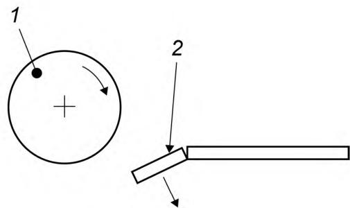
1 — каскадный диск; 2 — откидывающаяся крышка приемного стола
