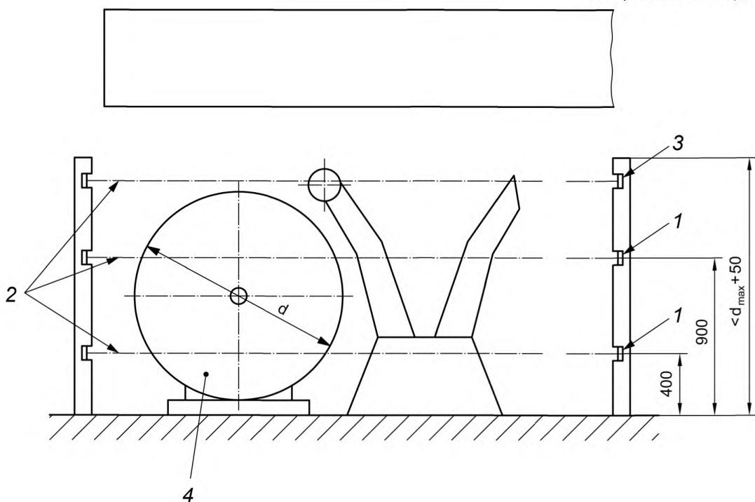
1 — ЭЧПУ; 2 — фотоэлектрический луч ЭЧПУ; 3 — дополнительное ЭЧПУ; 4 — рулон материала
