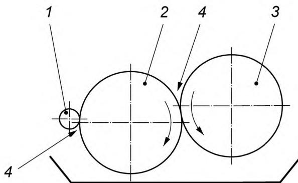
1 — дозирующий валик; 2 — дукторный валик; 3 — клеенаносящий валик;
