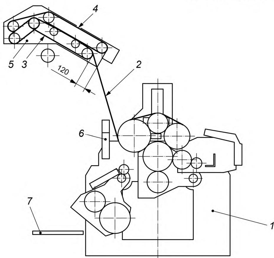
1 — агрегат для изготовления двухслойного гофрокартона; 2 — гофрированное полотно; 3 — нижняя лента транспортера;
