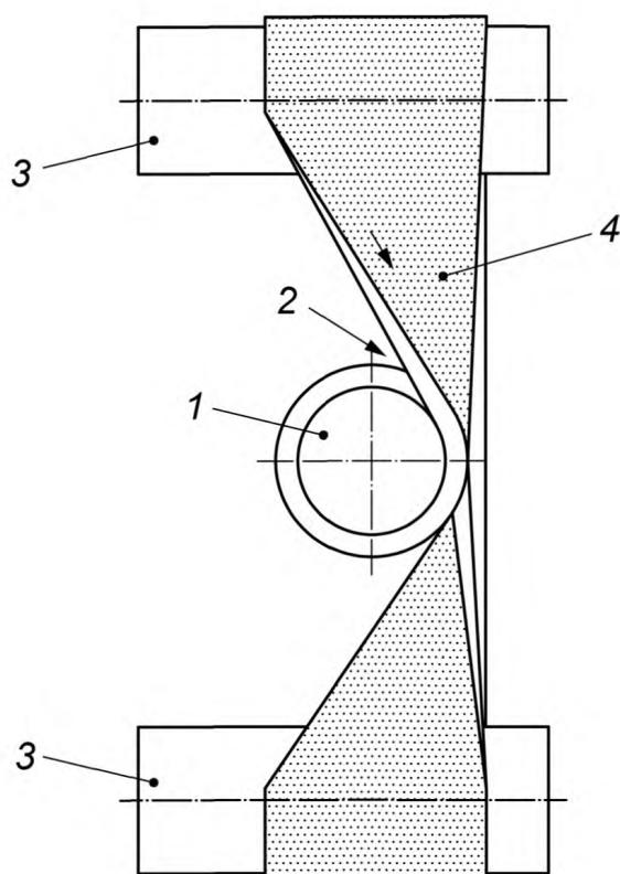
1 — навиваемый сердечник; 2 — место затягивания; 3 — вал привода ремня (приводной барабан);
