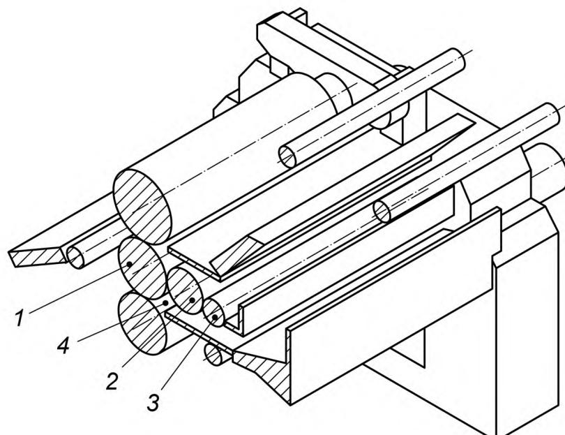
1 — гофрировальный вал; 2 — клеенаносящий вал; 3 — ракельный вал;
