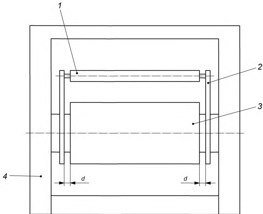
1 — обхватывающий валик; 2 — поворотный рычаг; 3 — нагревательный цилиндр; 4 — станина машины;
