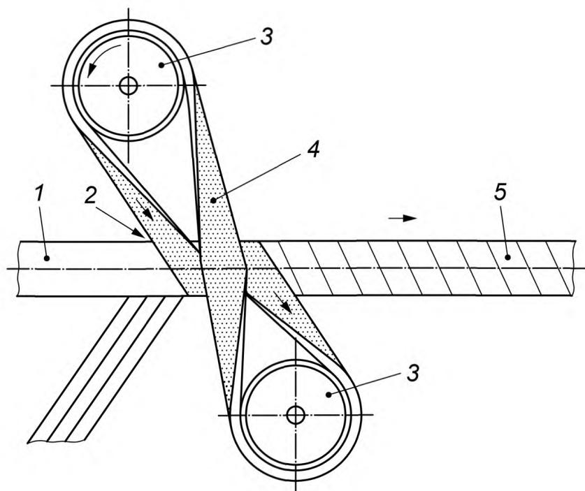
1 — навиваемый сердечник; 2 — место затягивания; 3 — вал привода ремня (приводной барабан);
