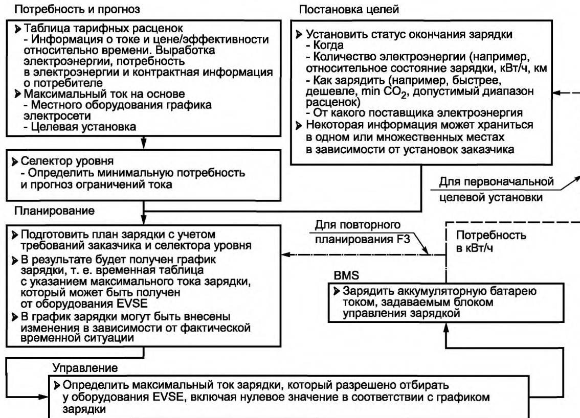
Рисунок А.6 — Временная диаграмма процесса зарядки
