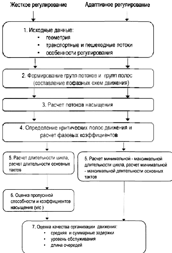
Рисунок 1.5 - Общая последовательность проектирования регулируемого перекрестка.
