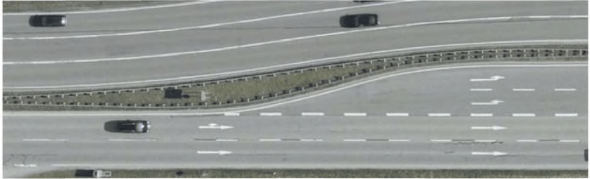
Рисунок 3.12 – Отгонка выделенных для поворотов полос: L - длина отгонки; R – радиус кривых в плане
