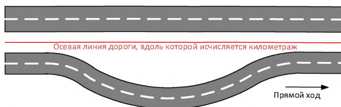
Рисунок - 4.4. Трассирование осевой линии при несимметричных проезжих частях дороги
