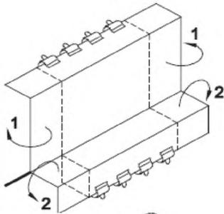
**Этап 2:** Закрепите корпуса под прямыми углами. Обогните в обратную сторону и сложите лишний материал покрытия.
