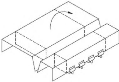
**Этап 1:** Закрепите покрытие позади шпильки и скобки к верхней и нижней частям корпуса, при открытом положении испытательного стенда и готовой набивкой.
