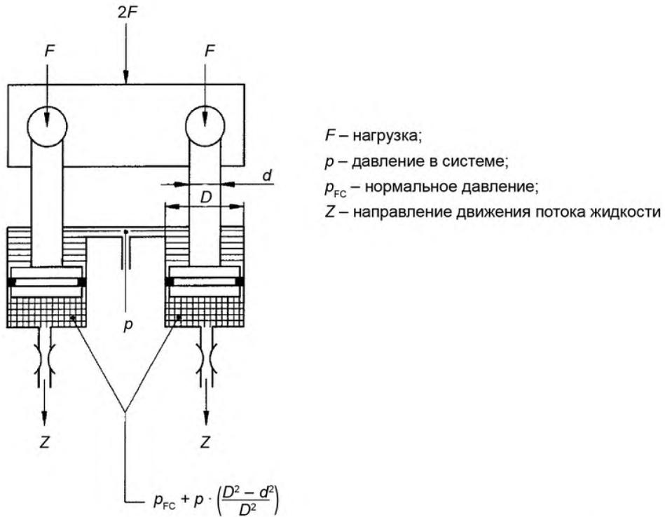
Рисунок 14 – Два цилиндра, работающие на сжатие; обычная работа
