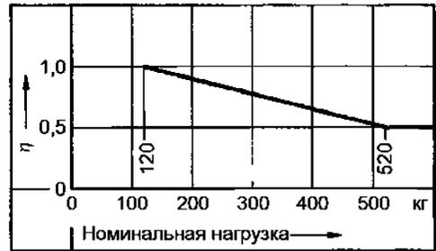
Рисунок 9 – Коэффициент диапазона нагрузки η
