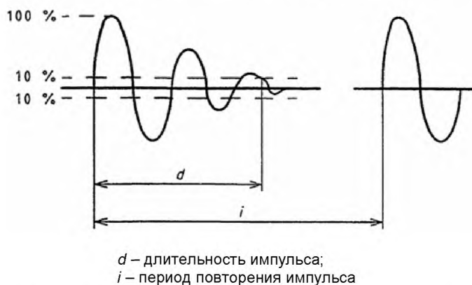
Рисунок G.1 – Кривая напряжения при сопротивлении R
