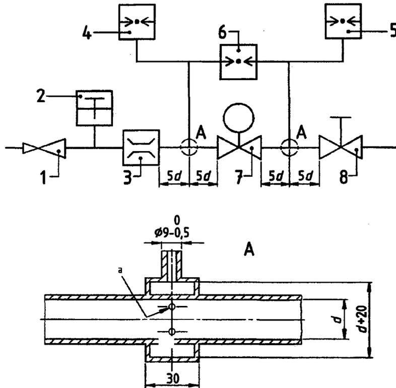
1 – регулятор давления на входе; 2 – термометр; 3 – расходомер;
