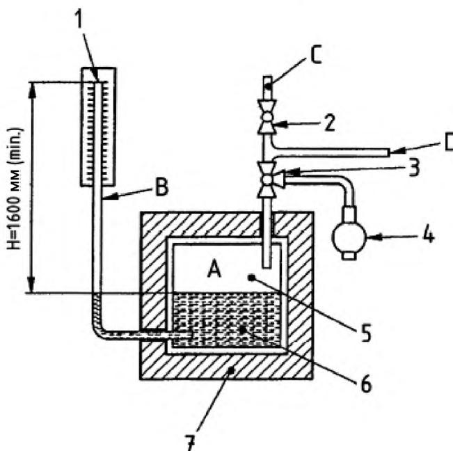
1 – миллиметровая шкала; 2 – вентиль; 3 – трехходовой кран; 4 – компрессор; 5 – объем воздуха 1 дм<sup>3</sup>;
