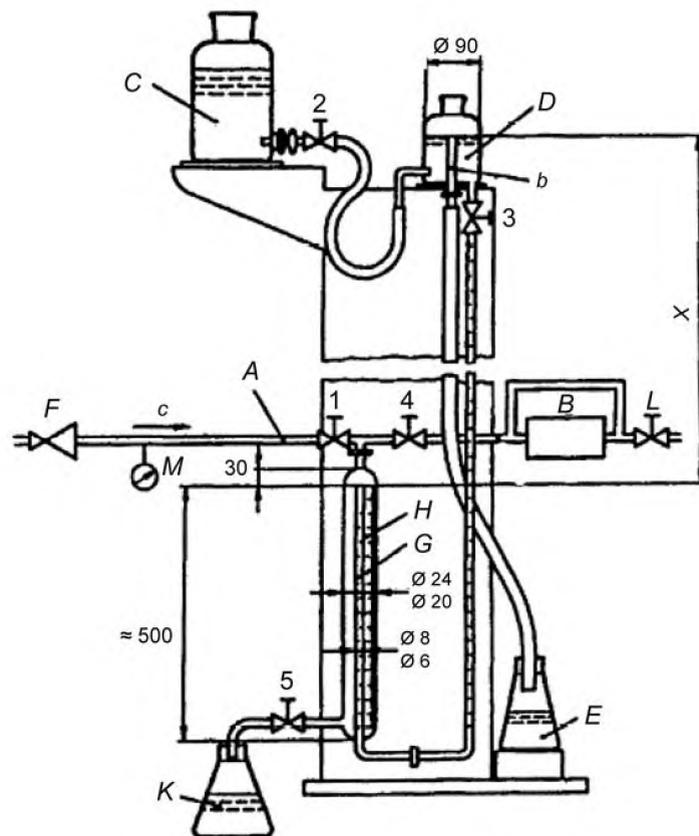
*A* – вход; *B* – испытуемый образец; *C* – емкость для воды; *D* – сосуд с постоянным уровнем воды;
