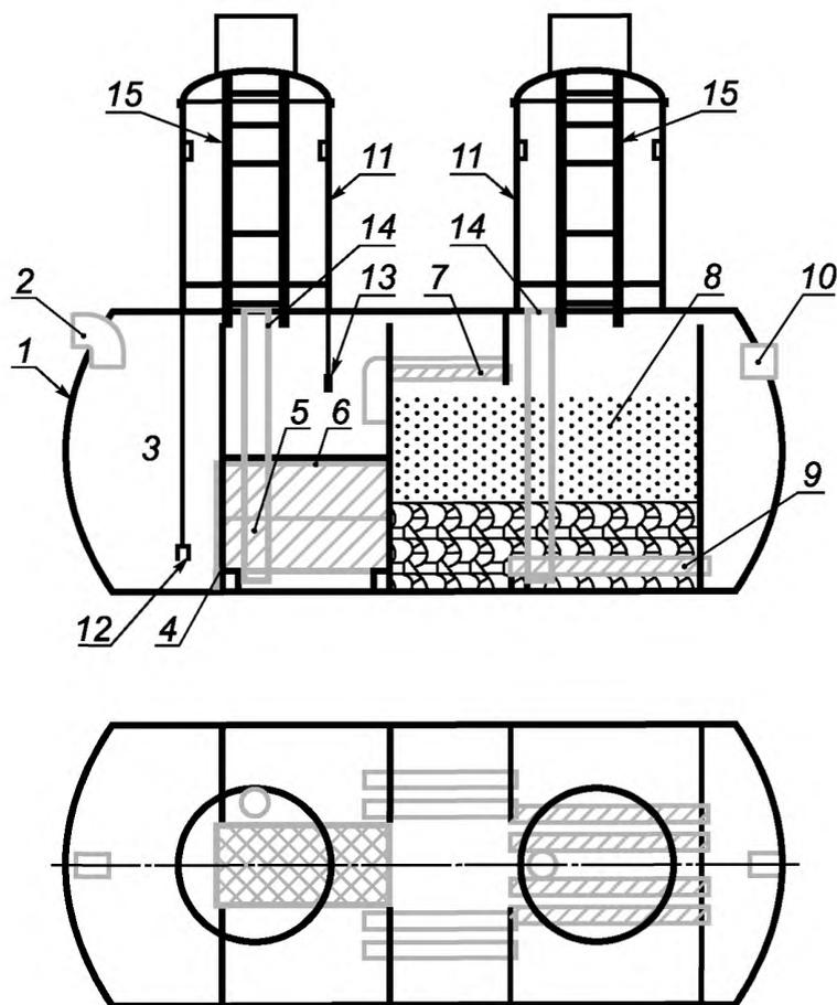
1 — корпус; 2 — входной патрубок; 3 — пескоотделитель; 4 — фильтр грубой очистки; 5 — коалесцентный модуль; 6 — фильтр тонкой очистки; 7 — распределительное устройство сорбционного фильтра; 8 — сорбционный фильтр; 9 — водосборное устройство; 10 — выходной патрубок; 11 — колодец обслуживания; 12 — сигнализатор уровня песка; 13 — контрольное устройство уровня раздела сред; 14 — лестница; 15 — лестница
