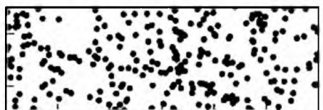
Рисунок А.9 – 16 процентов поверхности, 244 поры, d = 1 мм
