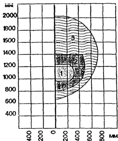
Рис. 3. Зоны расположения органов управления в вертикальной плоскости для среднего человека при работе стоя.
