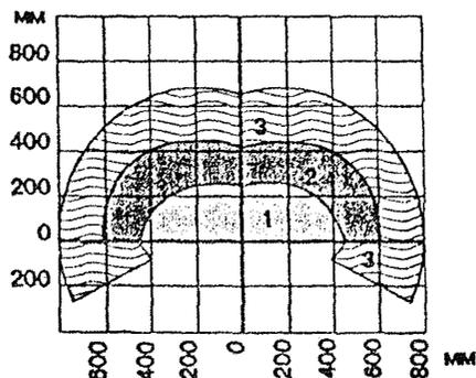
Рис. 4. Зоны расположения органов управления в горизонтальной плоскости для среднего человека при работе стоя.
