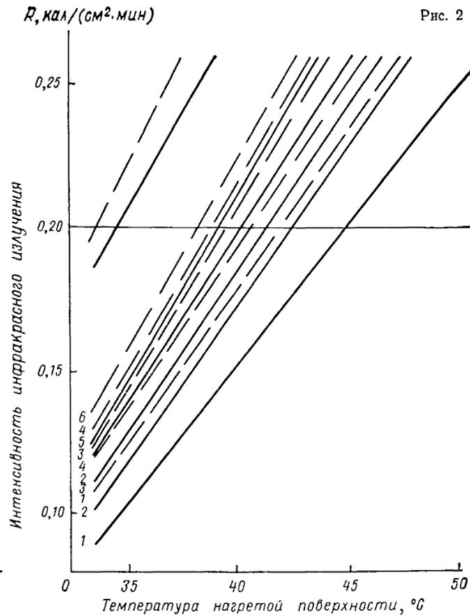
Ввиду отсутствия строго фиксированных рабочих мест в машинных и котельных отделениях судов измерение интенсивности инфракрасного излучения следует производить непосредственно у источников излучения (в 1 см от излучающей поверхности) на различных участках каждой из нагретой поверхности не менее чем в 5 точках.
