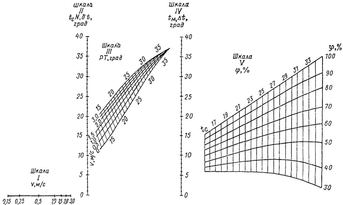
Номограмма для определения расчетных параметров воздуха судовых помещений по заданным результирующим температурам ( $^{\circ}$  PT)
