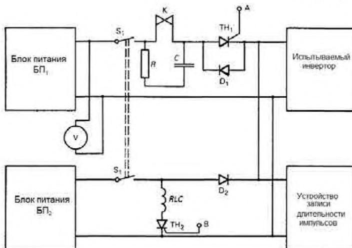
БП<sub>1</sub> – 2 %-ті реттеулі (нәлдік жүктемемен шекті жүктемеге дейін) кернеумен инвертор үшін талап етілетін импульсті токпен талап етілетін ең жоғары импульсті кернеуді бере алатын коректендіру блогы (кернеу ауқымының максимумы + X есептелген кернеу).
