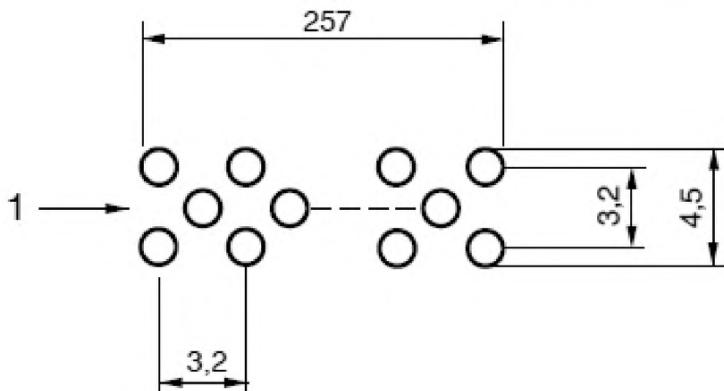
1 - Рабочая часть горелки имеет 242 отверстий диаметром 1,32 мм каждое на расстоянии 3,2 мм друг от друга, расположенные ступенчато в три ряда по 81, 80 и 81 в каждом.
