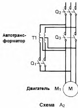
Рисунок 5 – Типичные способы и схемы пуска асинхронных двигателей переменного тока при помощи автотрансформаторов, лист 1
