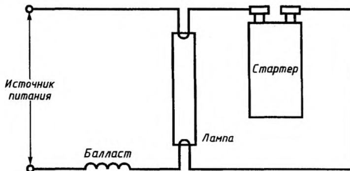
Рисунок 9 – Схема испытания стартеров на долговечность
