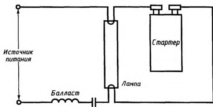
Рисунок 10 – Схема испытания стартеров на долговечность
