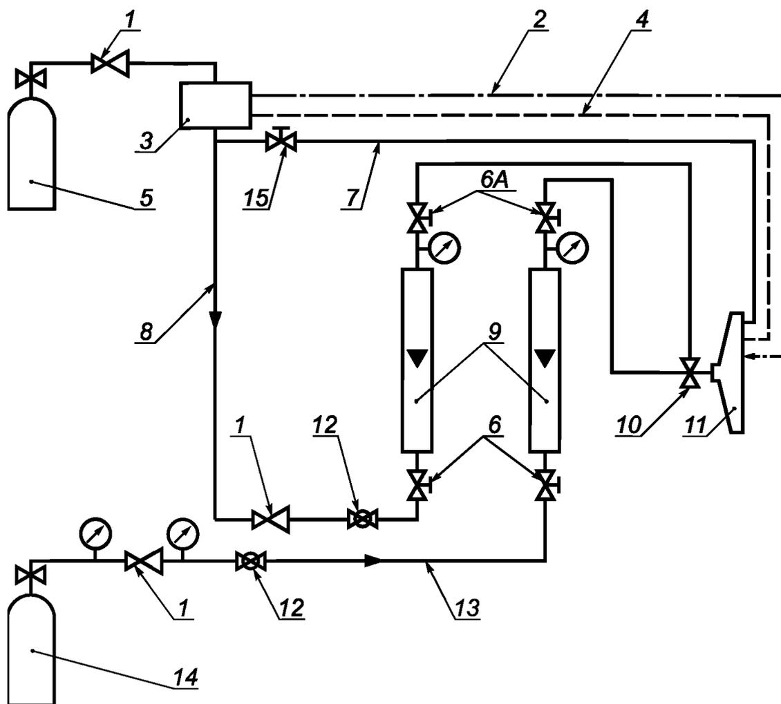
1 — регулятор; 2 — пьезоэлектрический воспламенитель; 3 — устройство защиты в случае отсутствия пламени; 4 — контрольные термопары; 5 — баллон с пропаном; 6 — винтовой клапан (6А — альтернативное расположение); 7 — вспомогательное питание; 8 — поток газа; 9 — расходомеры; 10 — смеситель Вентури; 11 — горелка; 12 — шаровой клапан; 13 — поток воздуха; 14 — баллон со сжатым воздухом; 15 — винтовой клапан вспомогательного питания
