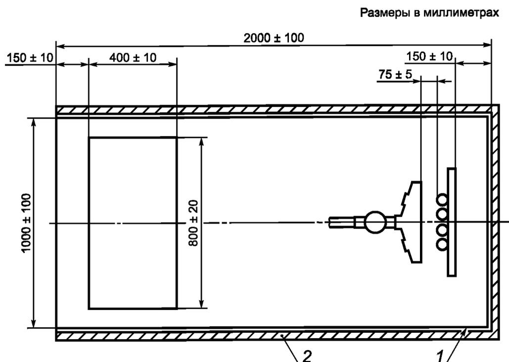
1 — стальной лист толщиной от 1,5 до 2 мм; 2 — термоизоляция из минеральной ваты толщиной приблизительно 65 мм с соответствующим внешним покрытием, обеспечивающим коэффициент теплопередачи около  $0,7 \text{ Вт} \cdot \text{м}^{-2} \cdot \text{К}^{-1}$
