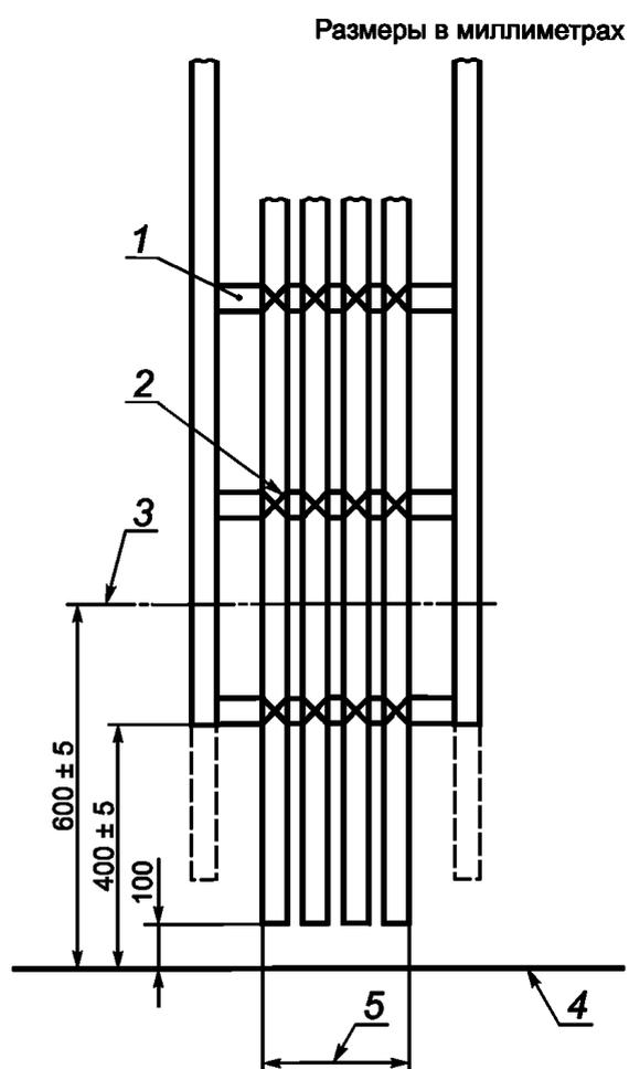
1 — круглые стальные перекладины; 2 — крепление металлической проволокой; 3 — центральная линия горелки; 4 — пол; 5 — максимальная ширина образца (в соответствии с категорией испытания)
