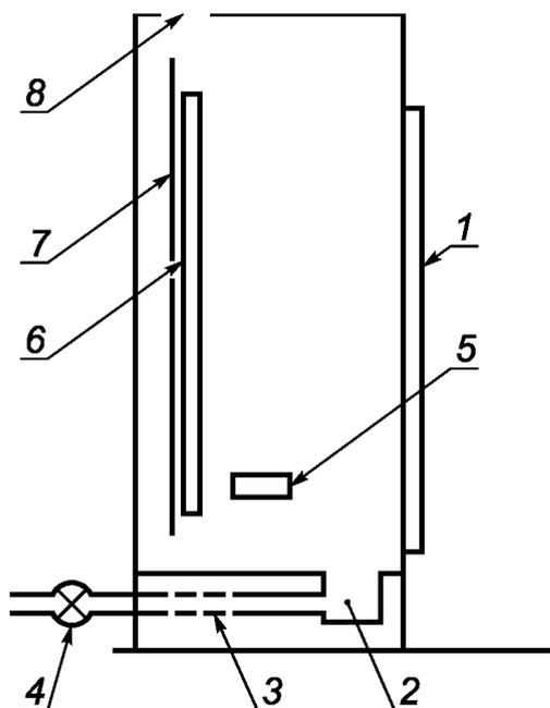
1 — дверца; 2 — короб для подачи воздуха; 3 — входной канал для подачи воздуха; 4 — вентилятор (примерное положение); 5 — горелка; 6 — испытуемые кабели; 7 — лестница; 8 — выходное отверстие для дыма
