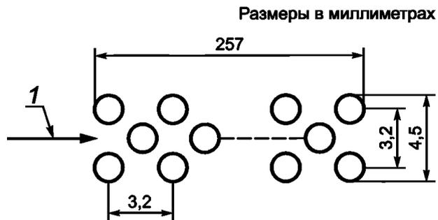
1 — рабочая часть горелки имеет 242 отверстия диаметром 1,32 мм каждое, расстояние между центрами которых 3,2 мм, расположенные ступенчато в три ряда по 81, 80 и 81 в каждом
