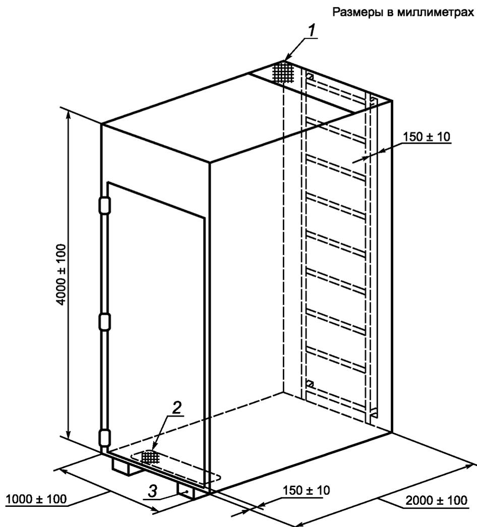
1 — выходное отверстие для дыма размером  $(300 \pm 30) \times (1000 \pm 100)$  мм; 2 — входное отверстие для воздуха размером  $(800 \pm 20) \times (400 \pm 10)$  мм; 3 — приспособление для обеспечения зазора между камерой и уровнем пола
